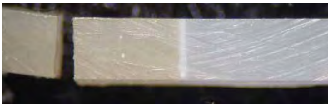
FIGURA 17 – Fratura coesiva em RCI (VMLC).
