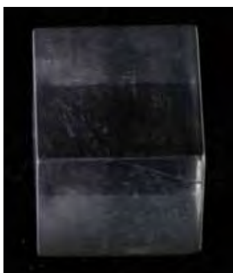
FIGURA 1- Padrão de resina acrílica para obtenção dos blocos de resina composta.
