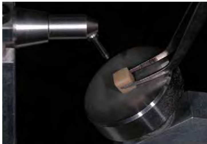
FIGURA 4- Jateamento com óxido se alumínio (Cojet Sand) por 10 s a uma distância de 10 mm com pressão de 2,8 bars.
