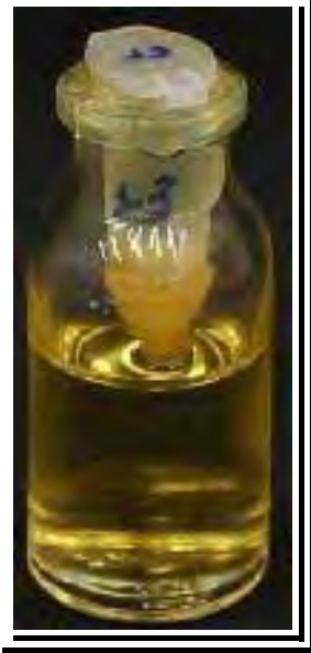
FIGURA 1 – Modelo do aparato para mensuração da microinfiltração.
