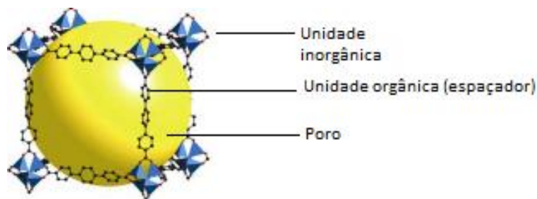
Figura 1. Representação estrutural de uma unidade de rede metalo-orgânica (MOF) (ABUÇAFY, 2015)
