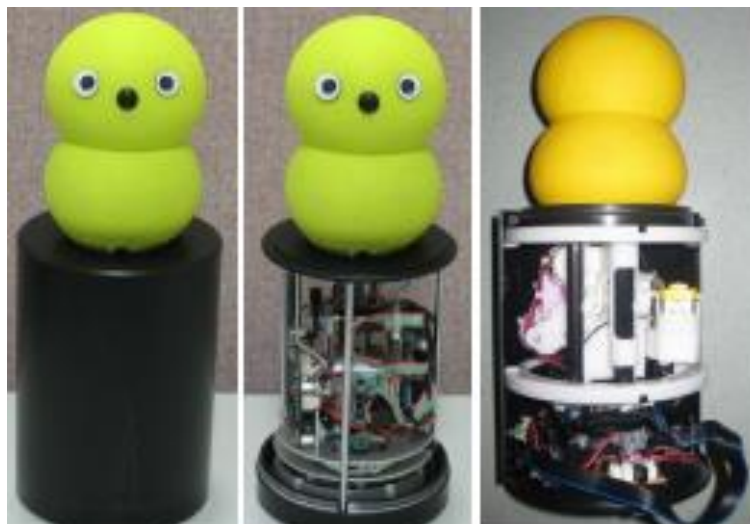
Figura 9 – Estrutura MyKeepon adaptada com servos motores.
