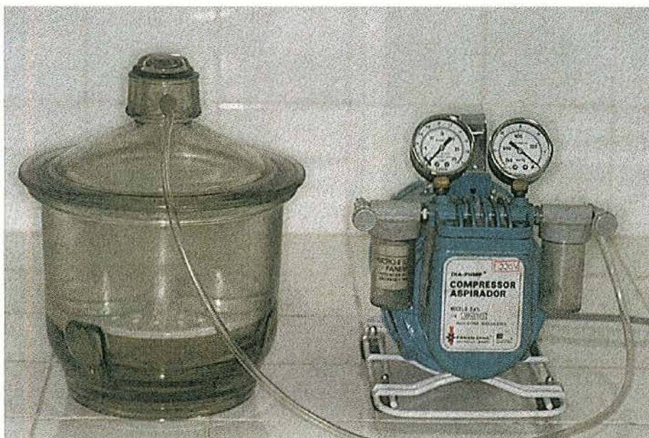
FIGURA 8 - Frasco acoplado a um compressor-aspirador utilizado para obtenção do vácuo.
