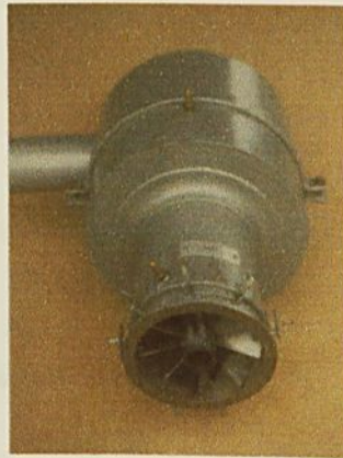
FIGURA 12- Foto do queimador com o estabilizador de chama tipo swirl utilizado por Lacava (2000).
