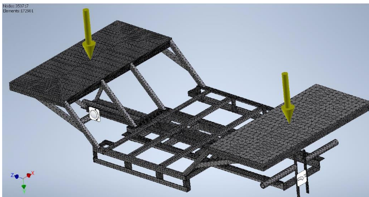
Figura 7 – Malha gerada por simulação computacional.
