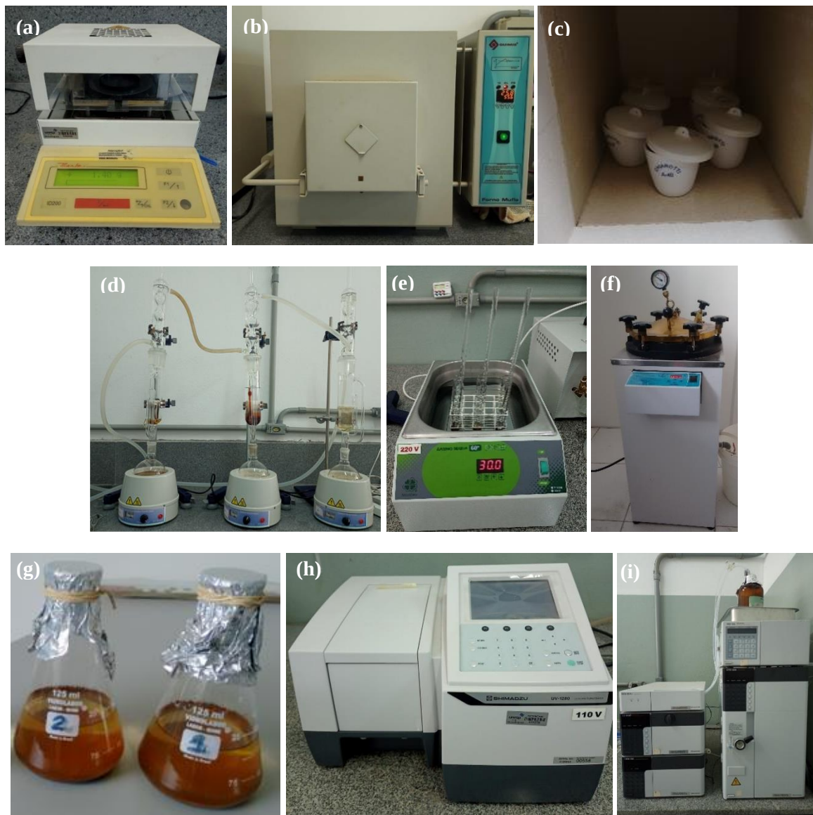
Figura 8 - Imagens dos equipamentos e amostras obtidas durante essa etapa: (a) balança com infravermelho utilizada para a determinação do teor dos sólidos; (b) mufla e (c) cadinho com amostra usados na calcinação; (d) sistema de extração Soxhlet; (e) banho térmico a 30 °C, (f) autoclave, (g) amostras hidrolisada obtidas no processo de hidrólise ácida; (h) espectrofotômetro de UV-visível; (i) cromatógrafo líquido de alta eficiência
