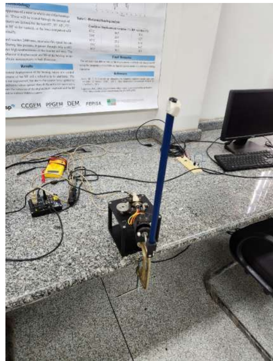
(b) Sistema de controle com massa adicional.
