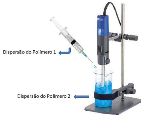
Figura 7 - Representação esquemática do processo de obtenção das nanopartículas poliméricas.
