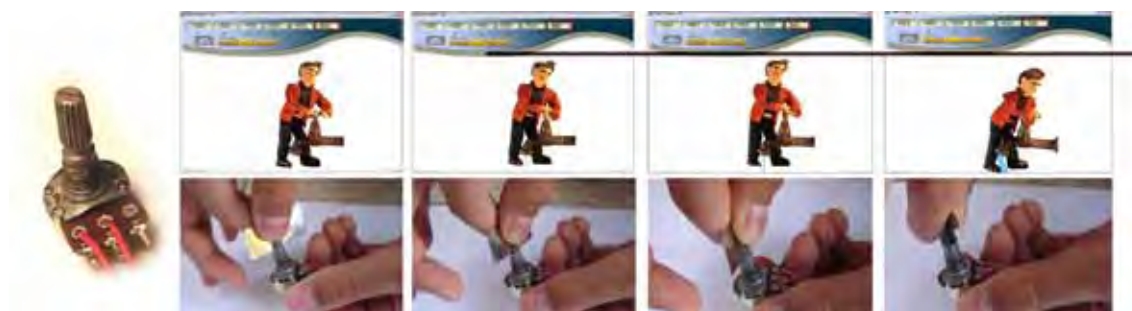
Figura 65: Sequência de animação controlada pela posição do potenciômetro rotativo.
