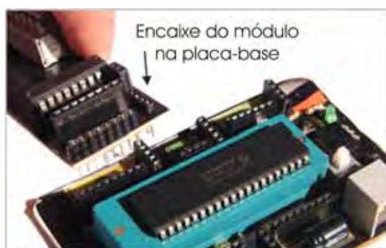
Figura 72: Montagem de módulo na placa-base.
