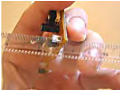
Figura 86: Teste de registro do deslocamento da régua convencional entre o emissor e detector de infravermelho.
