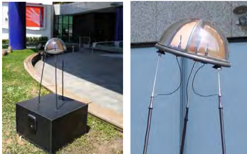
Figura 119: Protótipo acionado por motores de antenas automotivas e controlados pela placa GoGo board.
