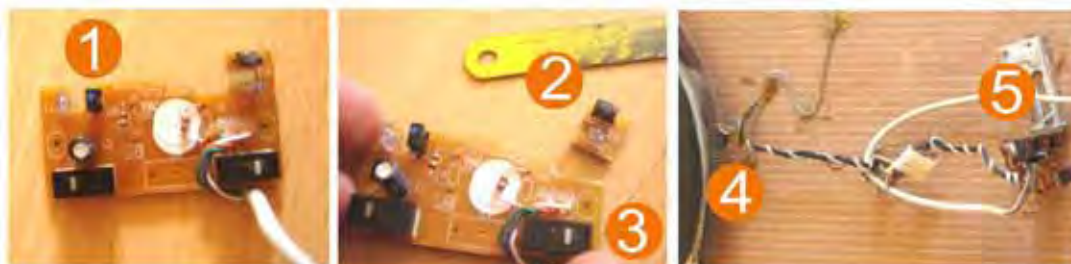
Figura 91: Adaptação do circuito do mouse.
