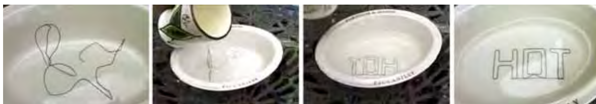
Figura 113: Um arame de nitinol , moldado na forma da palavra HOT que assume o formato quando aquecido com água quente.
