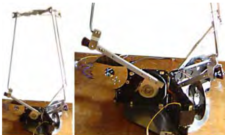
Figura 120: Protótipo com servo-motores em fase de montagem e testes.
