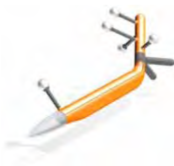
Figura 40: Ciber-stylus, mouse capaz de ler coordenadas em três dimensões.
