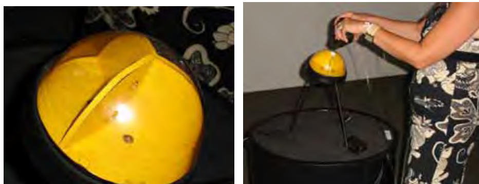
Figura 126: Cúpula com sensores para captação das luzes das lanternas.
