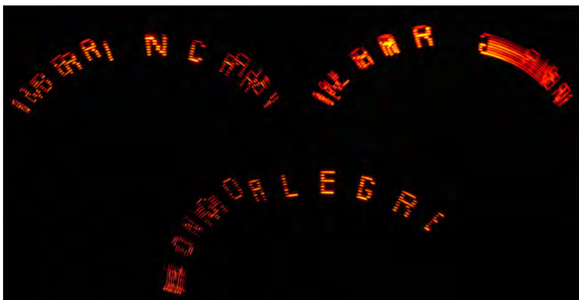
Figura 138: Falta de sincronia entre o circuito e mecanismo gerava palavras cortadas.
