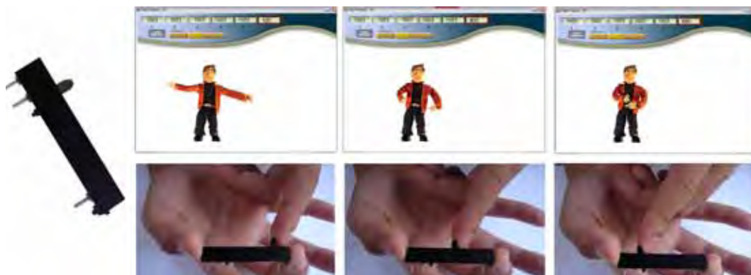
Figura 68: Seqüência de animação controlada pela posição do potenciômetro deslizante.
