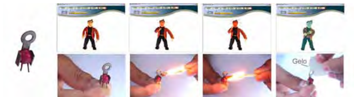
Figura 66: Sequência de animação controlada pela variação de temperatura capturada pelo sensor.
