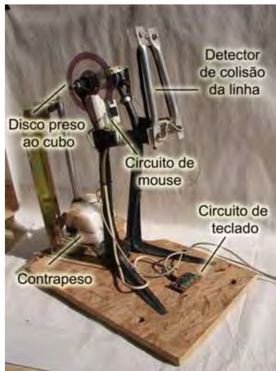
Figura 104: Elementos da interface.
