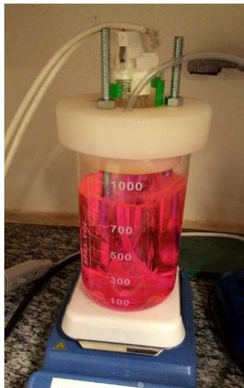
**Figura 9** – Célula fotocatalítica utilizada nos experimentos.
