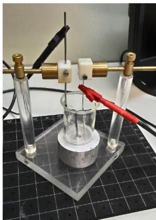
**Figura 10** – Célula eletroquímica de deposição.
