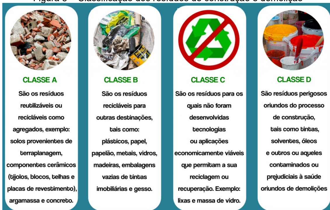
Figura 5 – Classificação dos resíduos de construção e demolição
