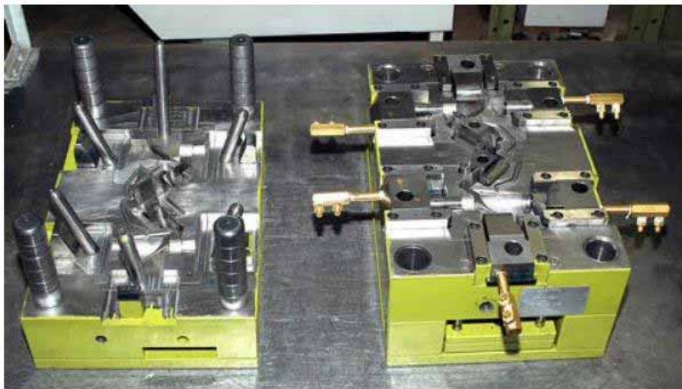
Figura 16: Partes de um molde com gaveta.
