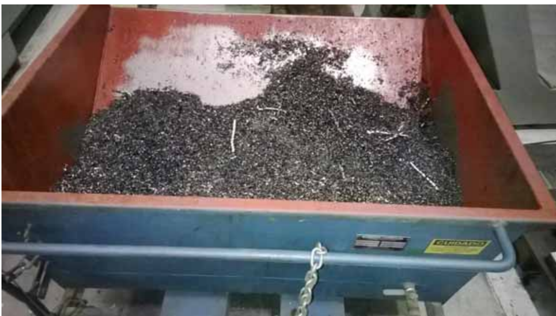
Figura 34: Armazenagem parcial do cavaco de aço contaminado. Fonte: Coleta de dados na empresa estudada.
