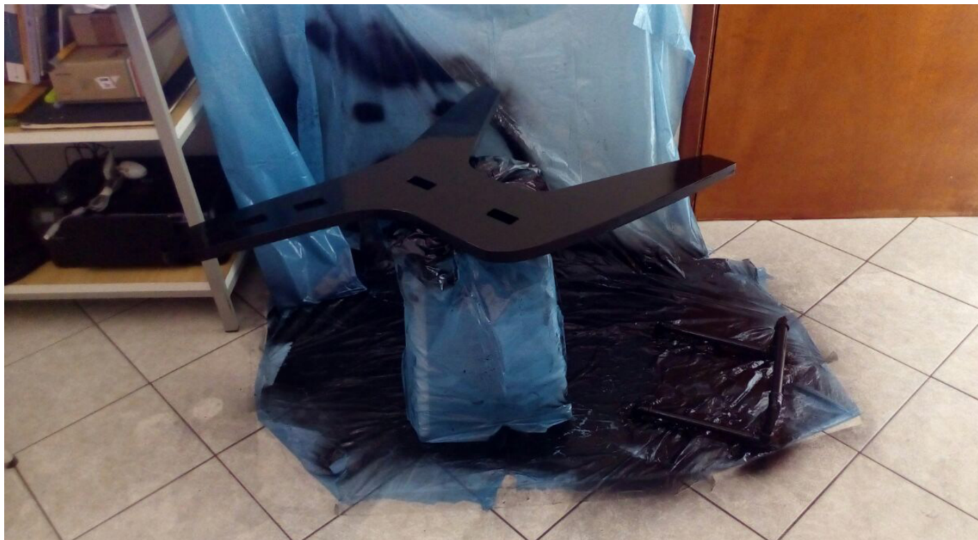
Fig.30 Lateral após a segunda camada de tinta.
