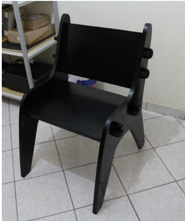
Fig.31 Teste dos encaixes após a pintura-
