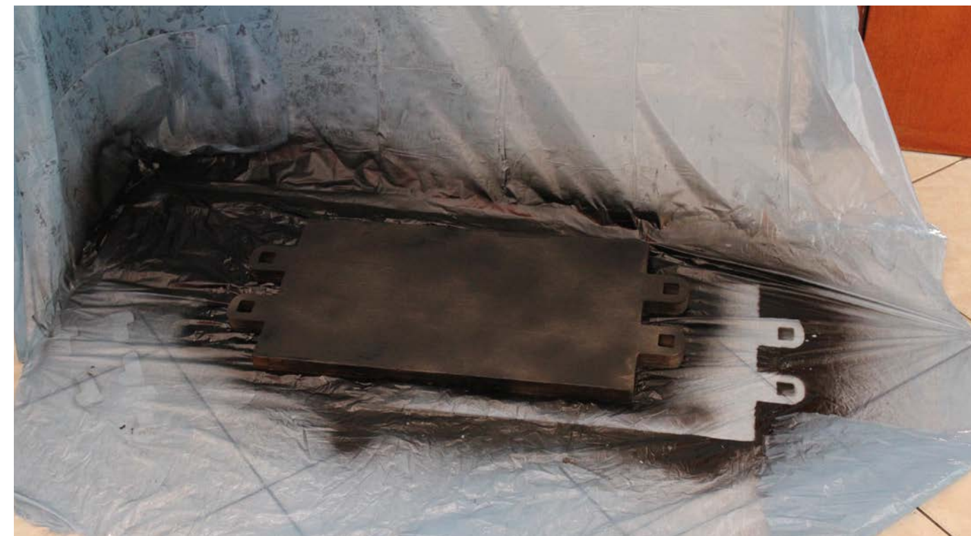
Fig. 28 Encosto com a primeira camada de tinta.
