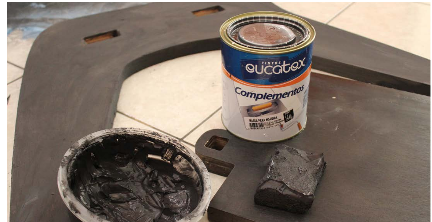
Fig. 24 Aplicação da mistura de massa para madeira com nanquim. Foi usado um pedaço de espuma para facilitar o processo e obter uma superfície mais lisa. Fig. 25 Peça lateral com a massa sendo
