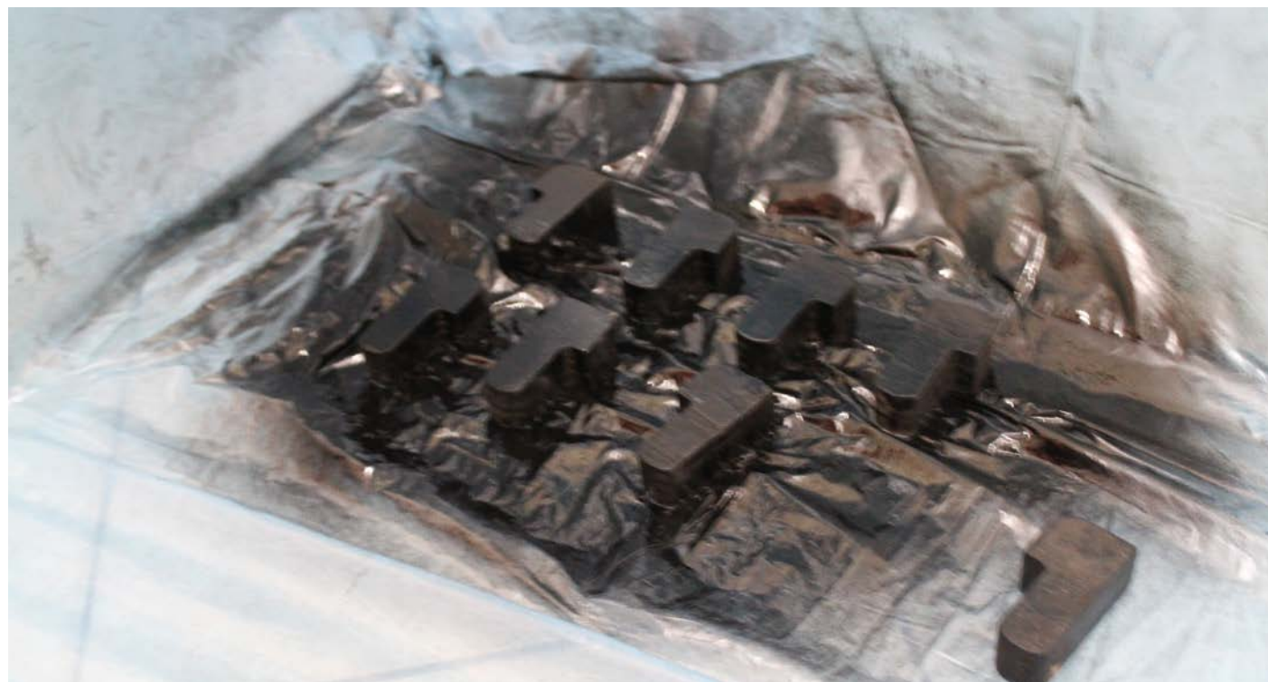
Fig. 27 Travas após receber a primeira camada de tinta.
