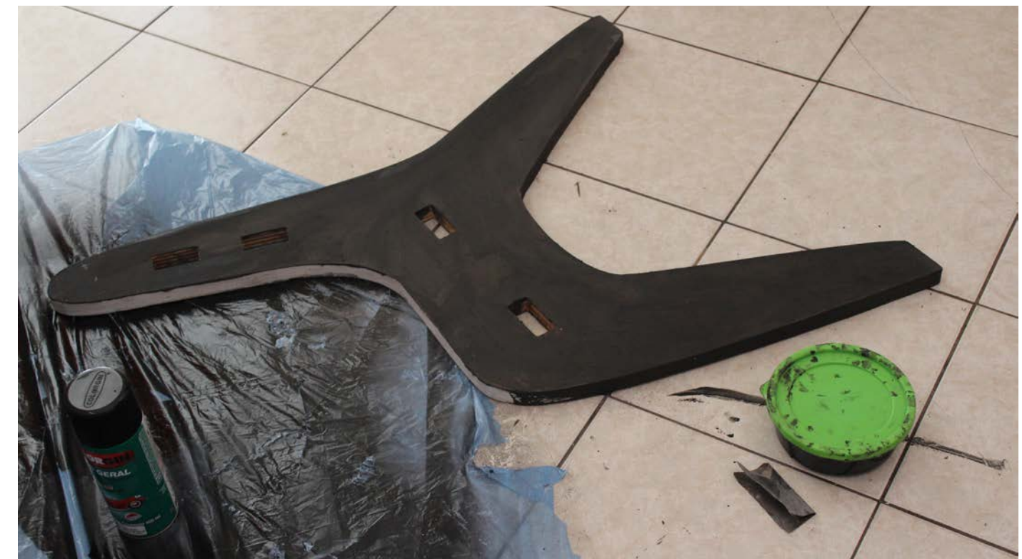
Fig. 24 Aplicação da mistura de massa para madeira com nanquim. Foi usado um pedaço de espuma para facilitar o processo e obter uma superfície mais lisa. Fig. 25 Peça lateral com a massa sendo
