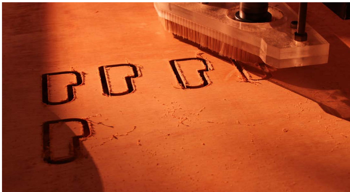
Fig. 18 Continuação do corte das travas para assento e encosto.
