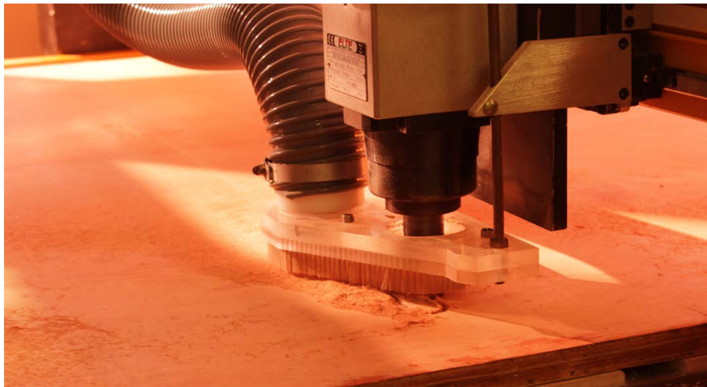
Fig. 17 Início do corte das travas para assento e encosto.
