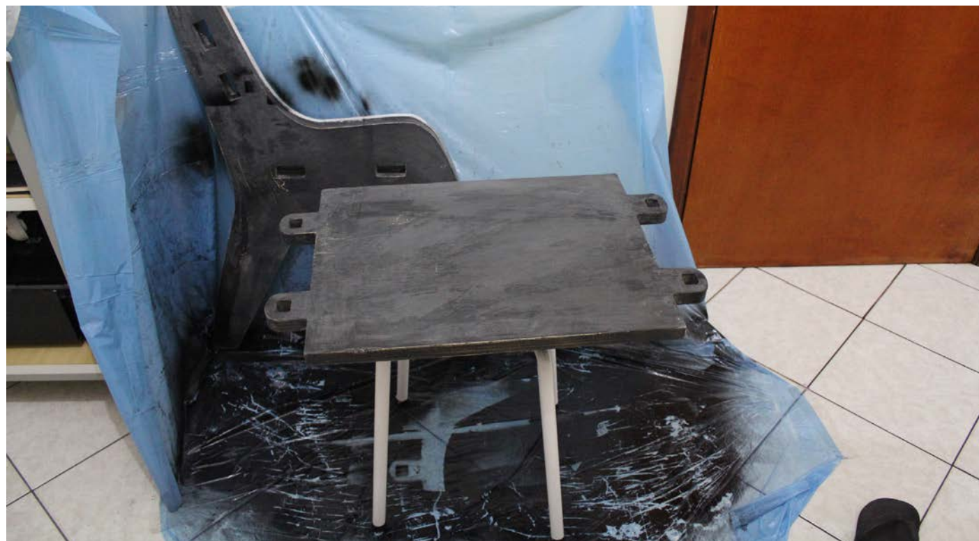
Fig. 26 Peças lixadas e prontas para receber a tinta.
