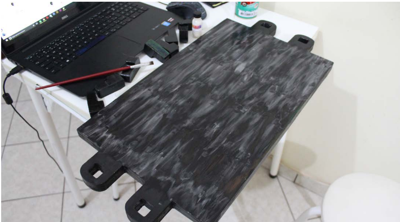
Fig. 33 Encosto após a aplicação do cristal líquido-
