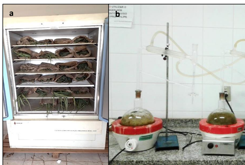
Figura 1 – Estufa para secagem de material vegetal (a); aparelho tipo Clevenger modificado (b)
