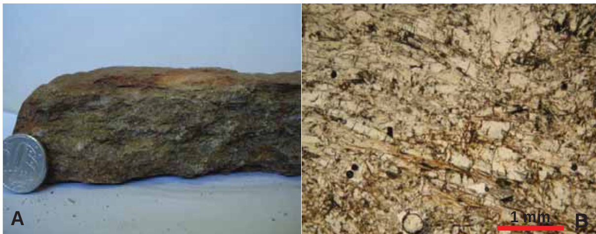
Figura 5.4: A: Amostra de clorita tremolita xisto razoavelmente intemperizada, exibindo coloração verde claro a escuro e granulação fina a média (Ponto 67). B: Fotomicrografia exibindo cristais de tremolita aciculares e orientados segundo Sn. Alguns são levemente esverdeados (Lâmina T-578-67).
