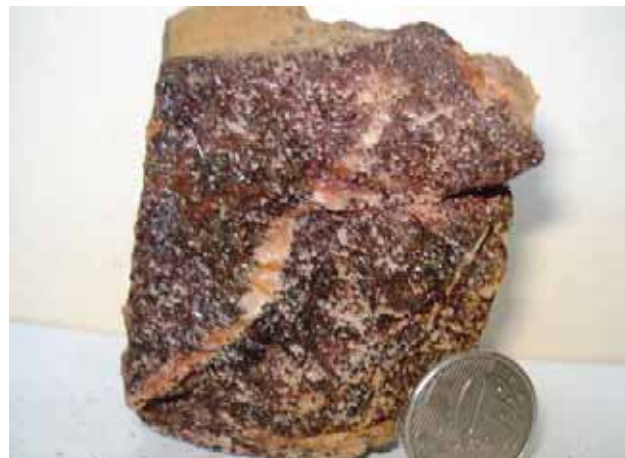
Figura 8.2: Bloco de veio de quartzo enriquecido em turmalina prismática e sem orientação (Ponto 218).
