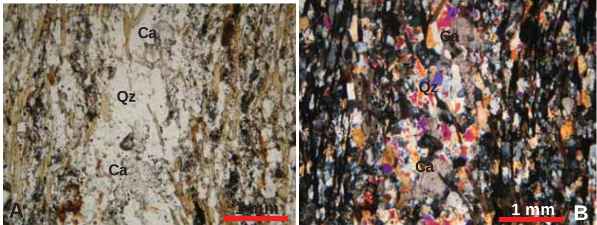
Figura 8.3: Fotomicrografia exibindo veio de quartzo com carbonato, interpretados como produtos de alteração hidrotermal na meta-graúvaca. O veio é concordante a foliação (Lâmina T-578-195). A: Polarizadores descruzados. B: Polarizadores cruzados.
