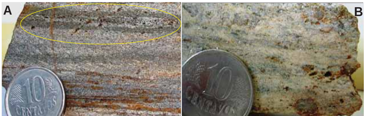
Figura 8.1: A: Destaque para as locações no topo da amostra de BIF (Ponto 181). B: Locações de possíveis cristais de sulfeto em amostra de granada muscovita quartzo xisto com turmalina e magnetita (Ponto 163).
