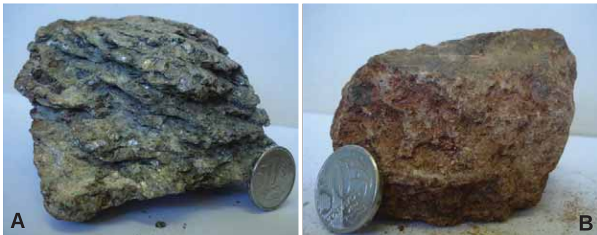
Figura 5.3: A: Amostra de rocha sã de talco-clorita xisto, com destaque para a estrutura xistosa dada pelas placas esverdeadas de clorita. Ponto 90, topo de pequeno morro. Em B , amostra representando o aspecto do talco clorita xisto quando já alterado.
