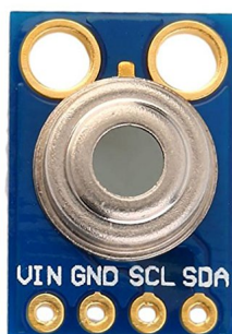
Figura 5 – Foto de um MLX90614 com a placa, já pronto para ser ligado diretamente num Arduino , por exemplo.
