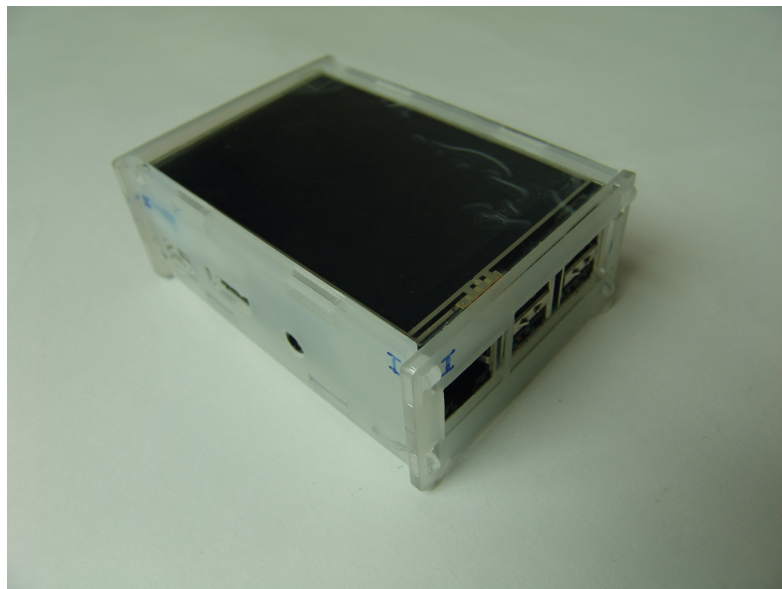
Figura 14 – Raspberry Pi com a tela sensível ao toque, dentro da capa.
