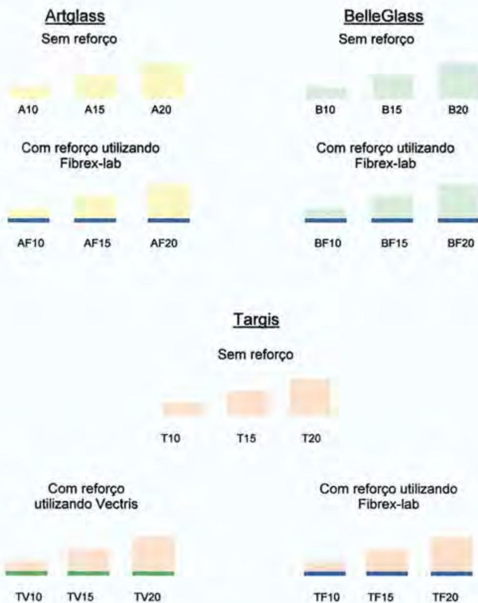
FIGURA 1 – Esquema representativo dos grupos de testes.
