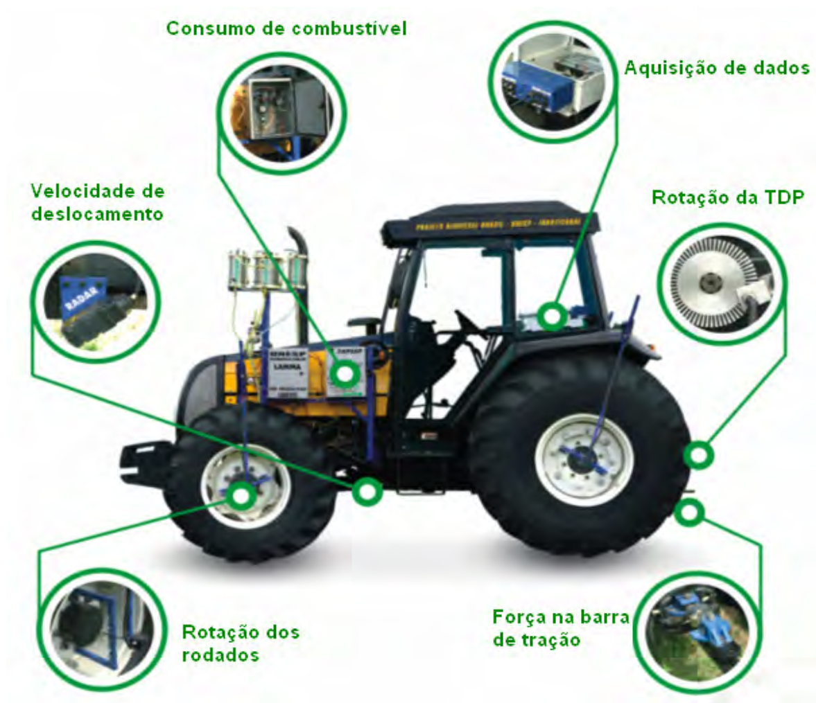
FIGURA 3. Vista lateral do trator de teste com instrumentação completa.
