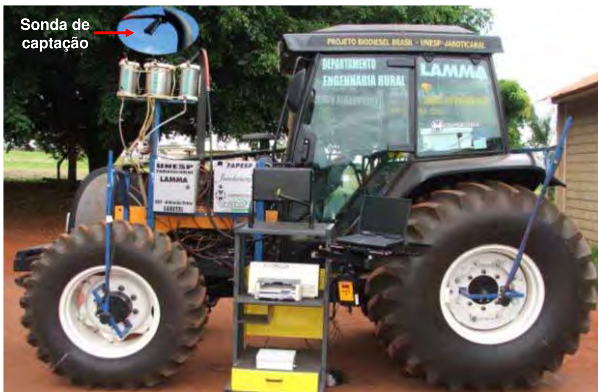
FIGURA 5. Vista geral do trator instrumentado para o ensaio de opacidade da fumaça.
