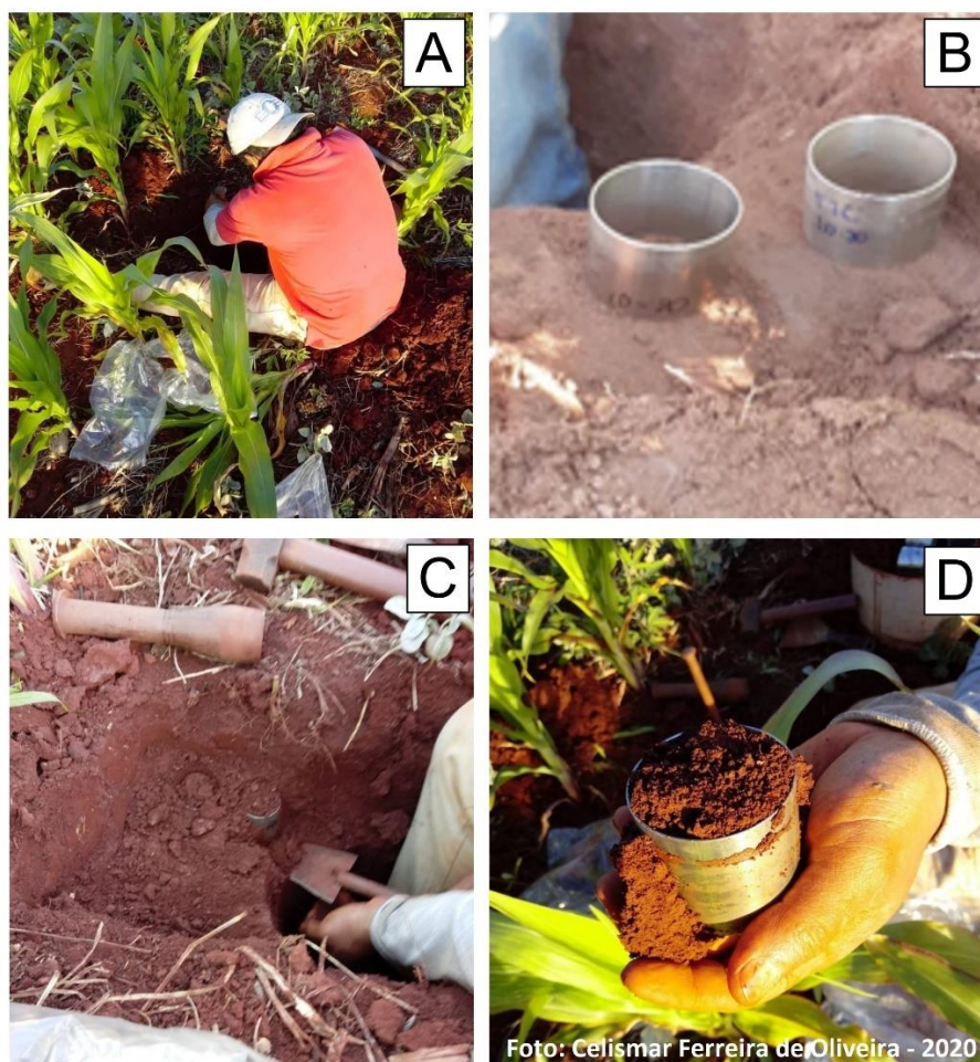
Figura 6 - Coleta das amostras de solo. (A) Limpeza da trincheira após escavação; (B) inserção dos anéis volumétricos; (C) retirada dos anéis com o auxílio de espátula metálica e (D) anel volumétrico preenchido com solo
