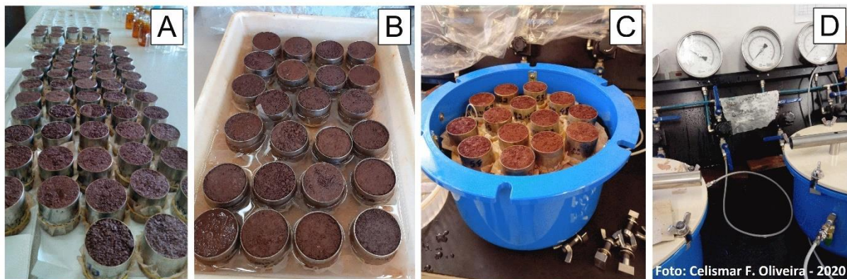
Figura 7 - Processamento das amostras para determinação de Pt, Map, Mip e CC. (A) Anéis volumétricos com tecido de organza; (B) amostras em bandeja plástica contendo água; (C) distribuição dos anéis na câmara de Richard; (D) regulação da pressão de extração da água das amostras
