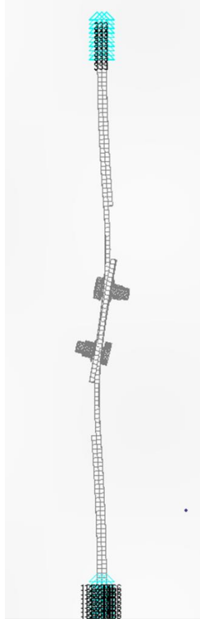
Figura 49 – Representação da mudança de forma do corpo de prova.
