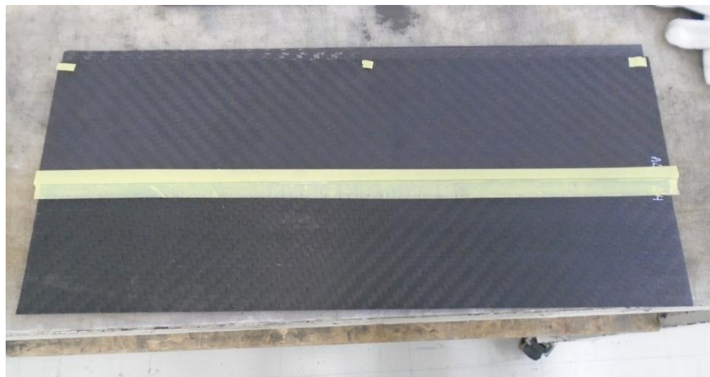
Figura 15 – Processo de colagem do tab sobre o laminado.
