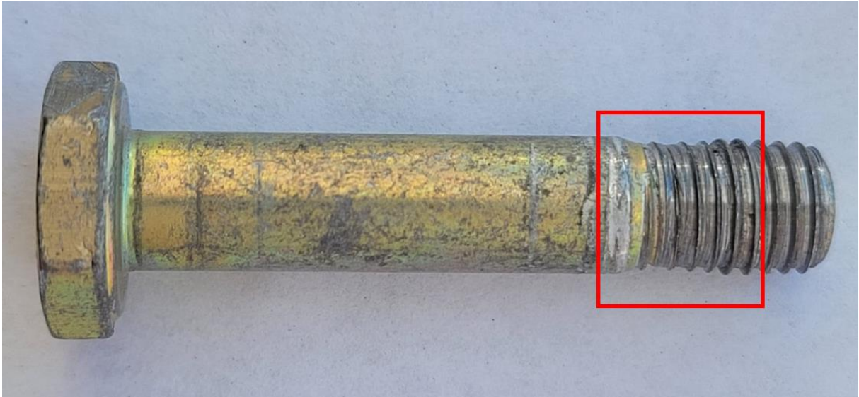
Figura 42 – Deformação plástica dos filetes de rosca – Configuração 3
