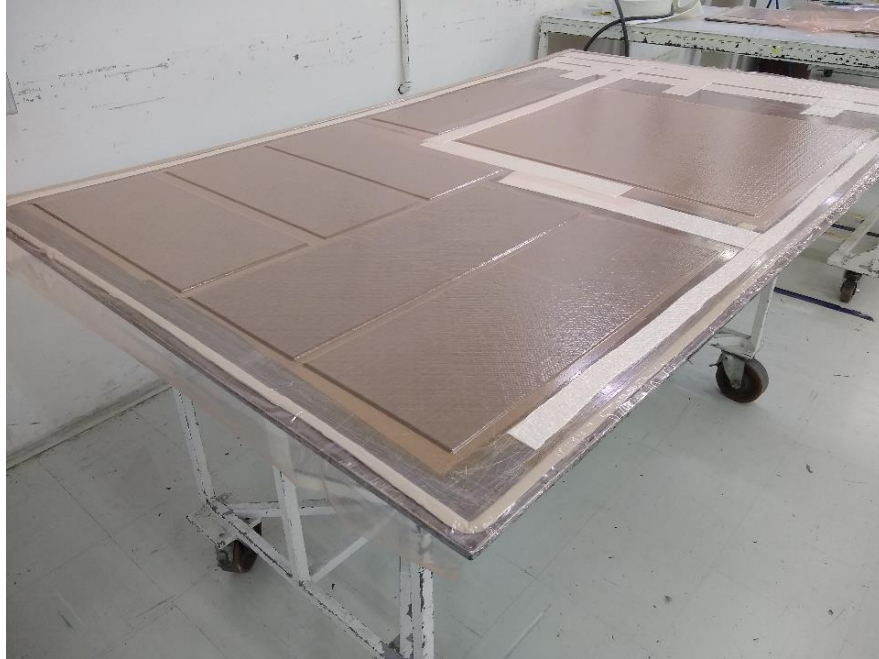
Figura 12 – Ferramental e os laminados sob compactação prévia.
