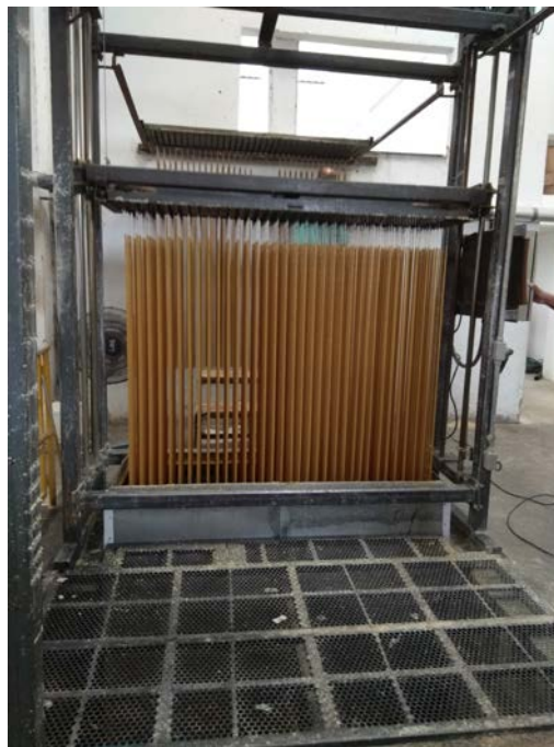
Figura 1 – Máquina atual de fabricação de velas de metro
