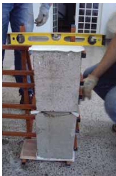
(d) Verificação do nivelamento
