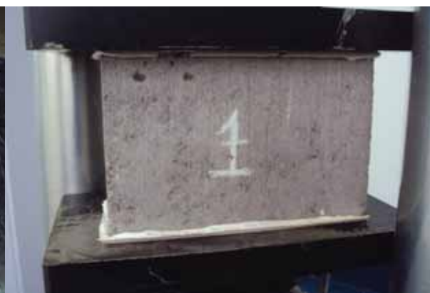
(b) Ensaio de compressão simples
