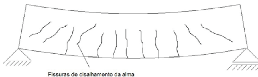
Figura 15 – Fissuras inclinadas originadas em vigas sujeitas a flexão
