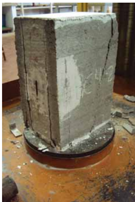
(a) Canaleta grauteada rompida
