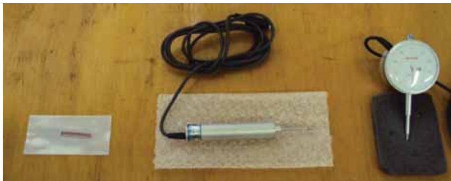
(a) Da esquerda para direita: Extensômetro elétrico, LVDT e relógio comparador
