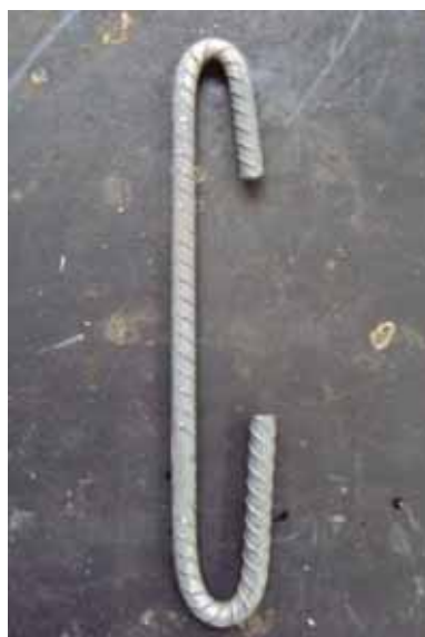
(a) Estribo \phi 6,3 mm – vigas canaletas
