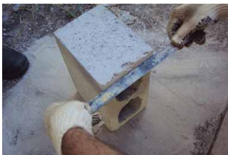
(b) Verificação da retificação da superfície raspada
