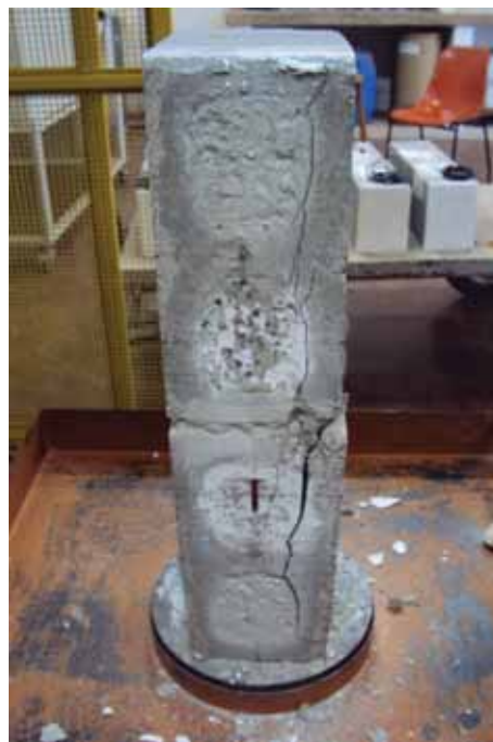
(b) Prisma de blocos grauteado rompido
