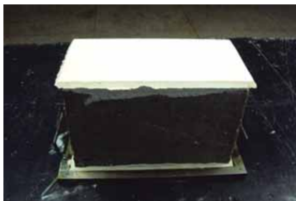
(a) Bloco capeado com gesso
