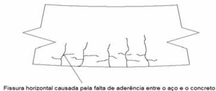
Figura 14 – Fissuras horizontais originadas em vigas sujeitas a flexão
