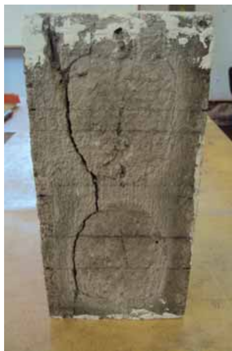
(b) Bloco grauteado rompido
