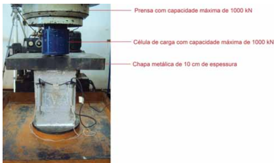
(a) Esquema de ensaio das canaletas e dos blocos grauteados
