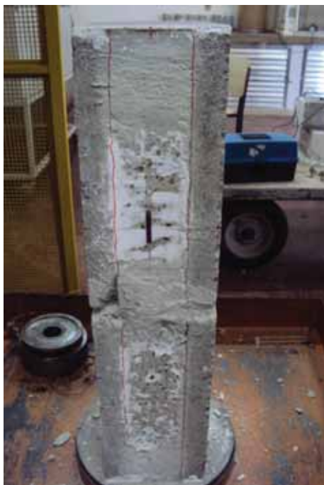
(a) Prisma de canaleta grauteado rompido
