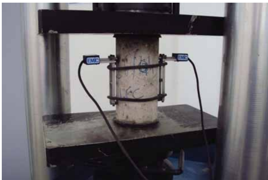
(a) Ensaio conjunto de compressão axial e módulo
