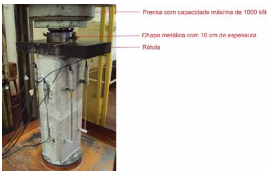
(b) Esquema de ensaio dos prismas grauteados
