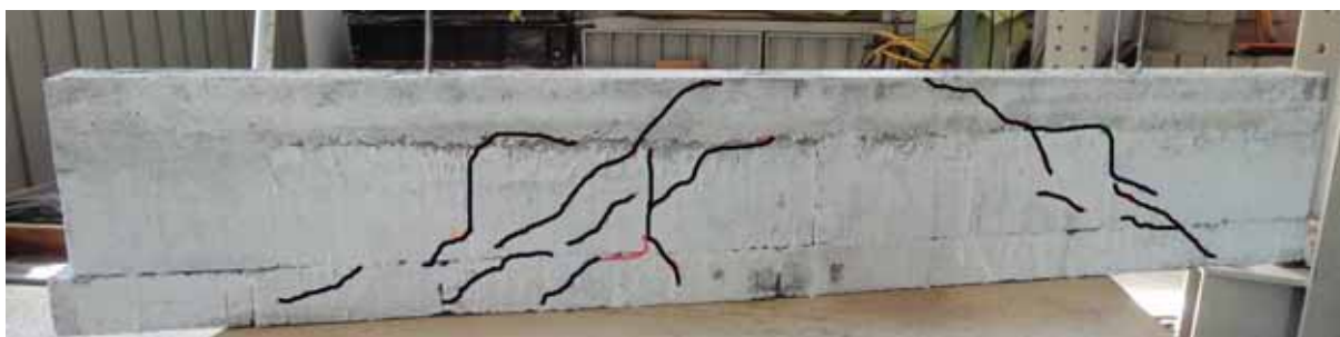
Figura 17 – Fissuras típicas de cisalhamento ocorridas na viga de alvenaria estrutural
