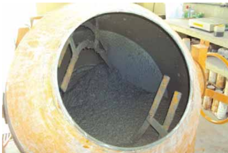
(a) Mistura dos materiais em betoneira
