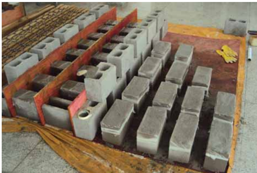
Figura 40 – Cura das canaletas e dos blocos grauteados
