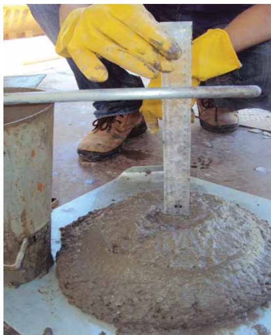
(c) Medição do abatimento do graute
