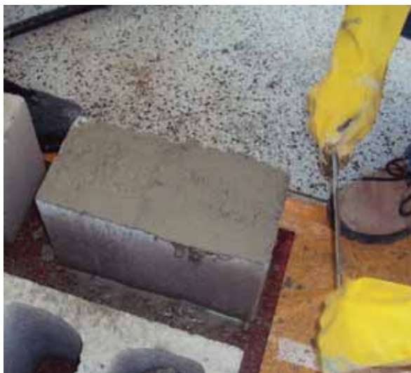
(c) Regularização da superfície
