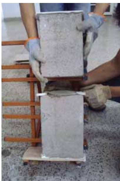
(c) Assentamento do bloco
