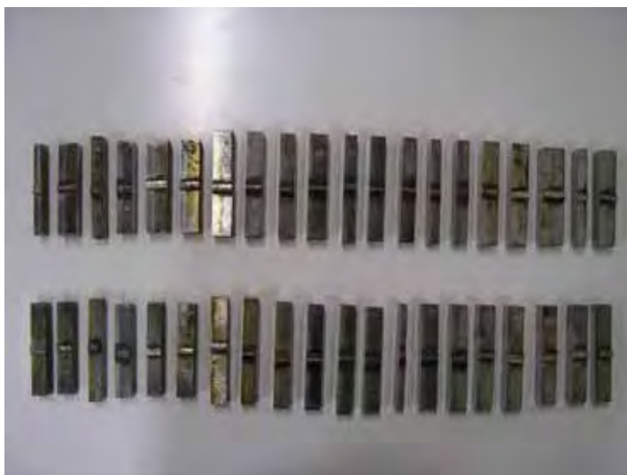
Figura 3.7 Totalidade de CDP'S utilizados para a realização de medidas de parâmetros geométricos do cordão.
