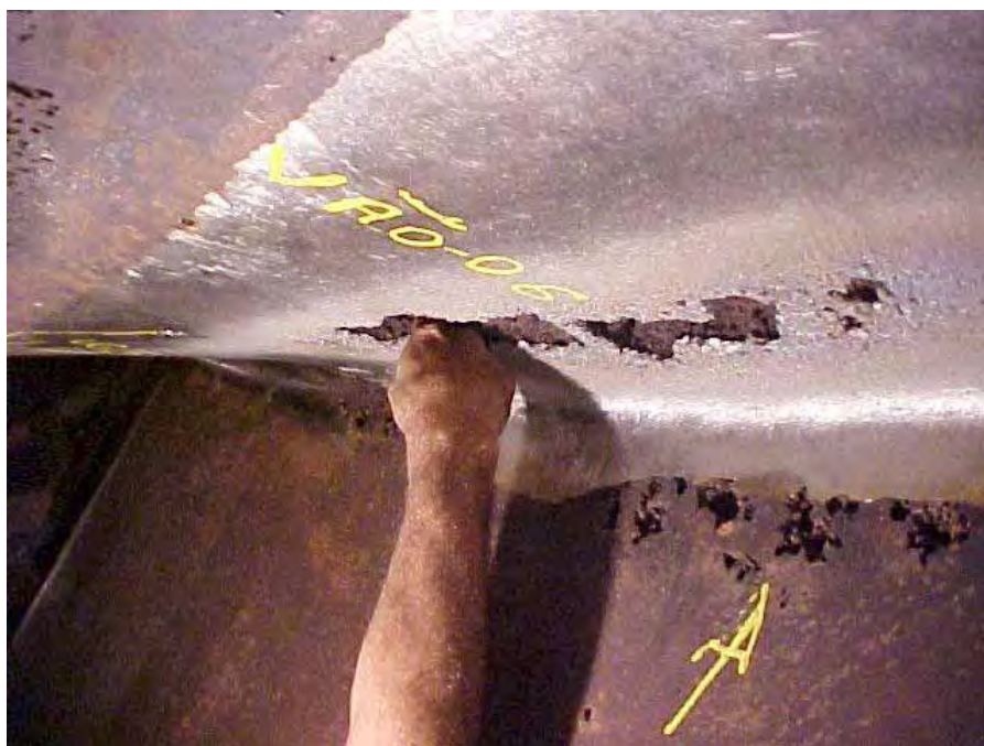
Figura 2.1 Erosão cavitacional em turbina hidráulica tipo Francis.
