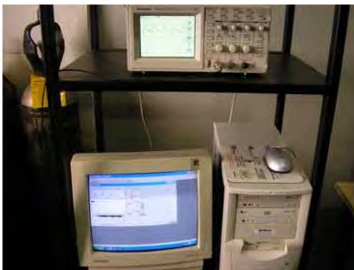
Figura 3.6 Sistema de aquisição dos tempos de arco aberto durante a realização dos cordões.
