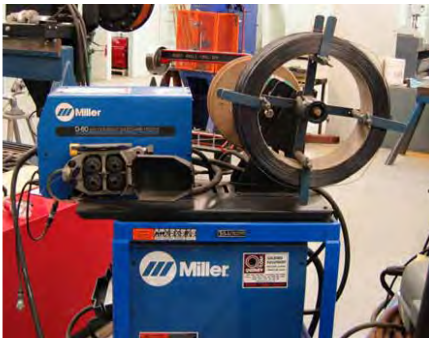
Figura 2.3 Exemplo de alimentador de arame utilizado na soldagem GMAW. ( http://commons.wikimedia.org/wiki/Image:Welding_wire_feeder-Miller-D60-side-triddle.jpg , julho, 2007.).
