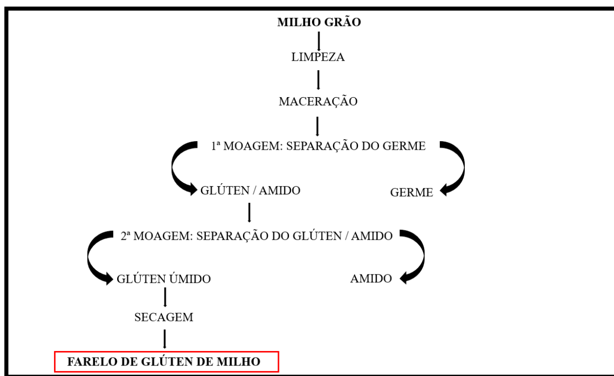
Figura 1: Fluxograma do processo de moagem úmida do milho, com destaque para a obtenção do Farelo de Glúten de Milho. Adaptado de: Fernandes, 2003.
