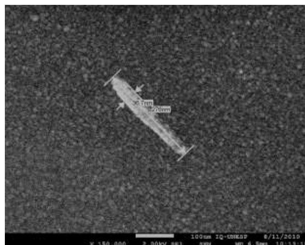
Figura 17 - AFM da suspensão dos nanocristais de celulose bacteriana obtidos em 50 minutos de hidrólise ácida.
