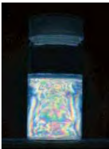
Figura 10 - Imagem de uma suspensão (0,63% em massa) de NCC de celulose bacteriana, observada entre polarizadores cruzados. 27
