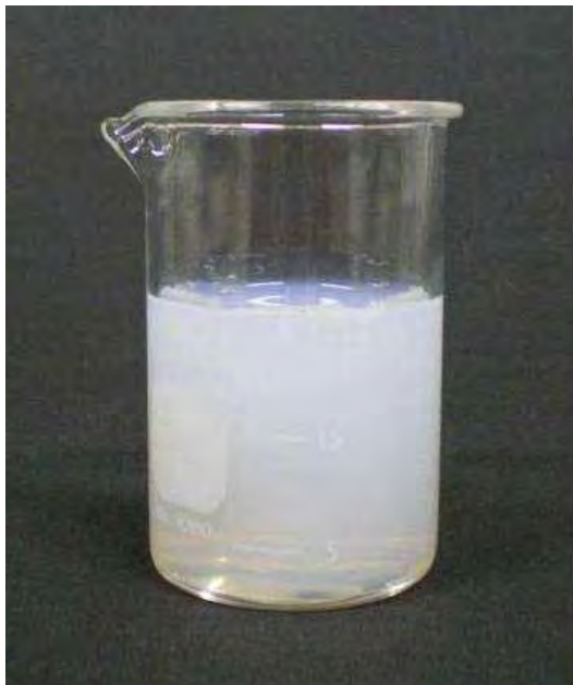
Figura 14 - Fotografia da suspensão de nanocristais de celulose bacteriana de concentração 1% (m/m).
