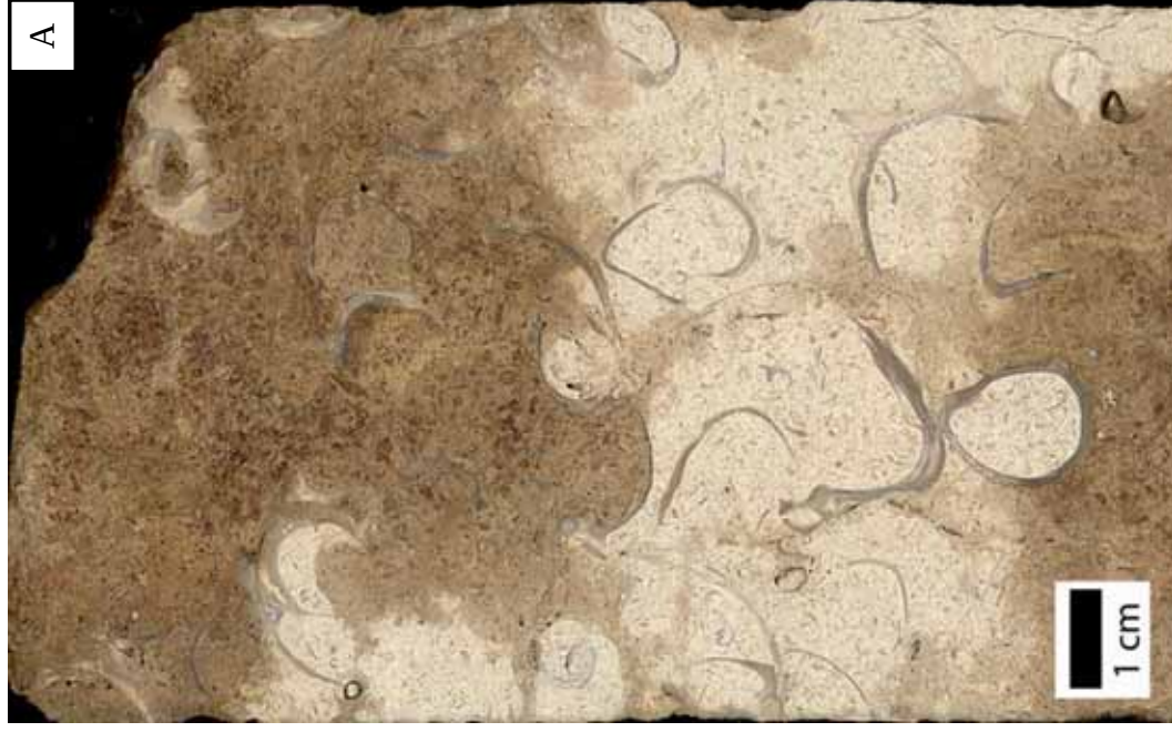
Estampa 5: Imagens obtidas em scanner de seções de testemunho representativa das fácies F e G. A: packstone bioclástico da fácies F. Fragmentos de bivalves encontram-se dispersos em uma rocha de estrutura mosqueada, com manchas de cimentação e saturação em óleo (Poço A-3, prof. 1787,55m). B: wackestone/packstone oolítico da fácies G, mostrando textura granular e manchas castanho-escuras, provavelmente com saturação em óleo (Poço A-3, prof. 1775,80m).
