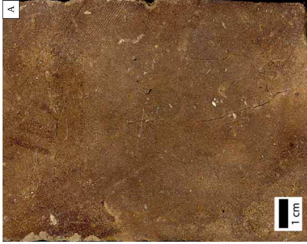
Estampa 7: Imagens obtidas em scanner de seções de testemunho representativa das fácies H e I. A: Rocha fina, de cor castanha e estrutura maciça (Poço A-10, prof. 1791,00m). B: intercalação entre wackestone a calcsiferas (mais claro e maciço/mosqueado) e marga (mais escuro e laminado) da fácies I (Poço A-3, prof. 1770,70m).
