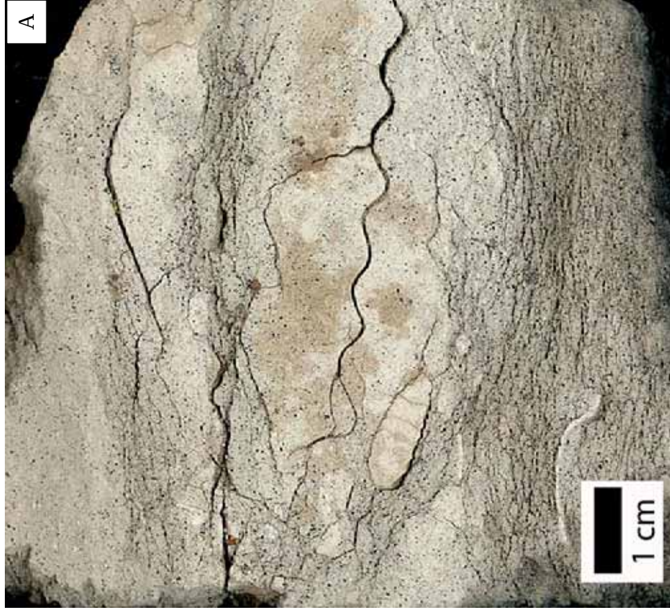
Estampa 8: Imagens obtidas em scanner de seções de testemunho representativa das fácies J e K. A: wackestone bioclástico da fácies J, onde os pequenos pontos escuros são grãos de glauconita (Poço A-3, prof. 1778,15m). B: Carbonato cristalino acinzentado, de estrutura maciça e com boa porosidade (Poço A-49, prof. 1846,20m).
