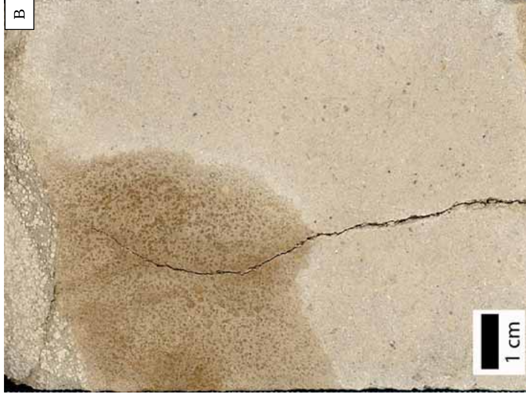
Estampa 5: Imagens obtidas em scanner de seções de testemunho representativa das fácies F e G. A: packstone bioclástico da fácies F. Fragmentos de bivalves encontram-se dispersos em uma rocha de estrutura mosqueada, com manchas de cimentação e saturação em óleo (Poço A-3, prof. 1787,55m). B: wackestone/packstone oolítico da fácies G, mostrando textura granular e manchas castanho-escuras, provavelmente com saturação em óleo (Poço A-3, prof. 1775,80m).
