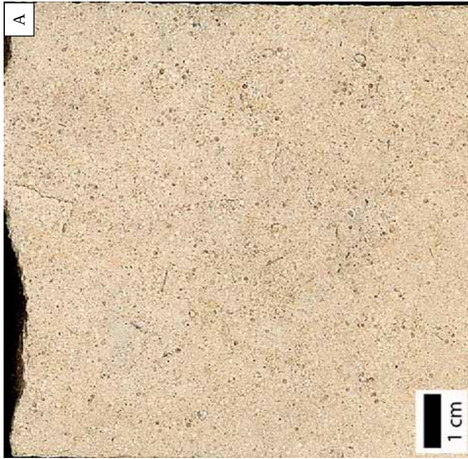
Estampa 1: Imagens obtidas em scanner de seções de testemunho representativa das fácies A e B. A: grainstone oolítico com grãos compostos da fácies A, com estrutura maciça e coloração acinzentada devido à cimentação (Poço A-10, prof. 1874,65m). B: grainstone oncolítico da fácies B, com estrutura maciça a mosqueada, exibindo um tubo de escavação ( burrowing ) preenchido por sedimento indicado pela seta vermelha (Poço A-10, prof. 1842,30m).
