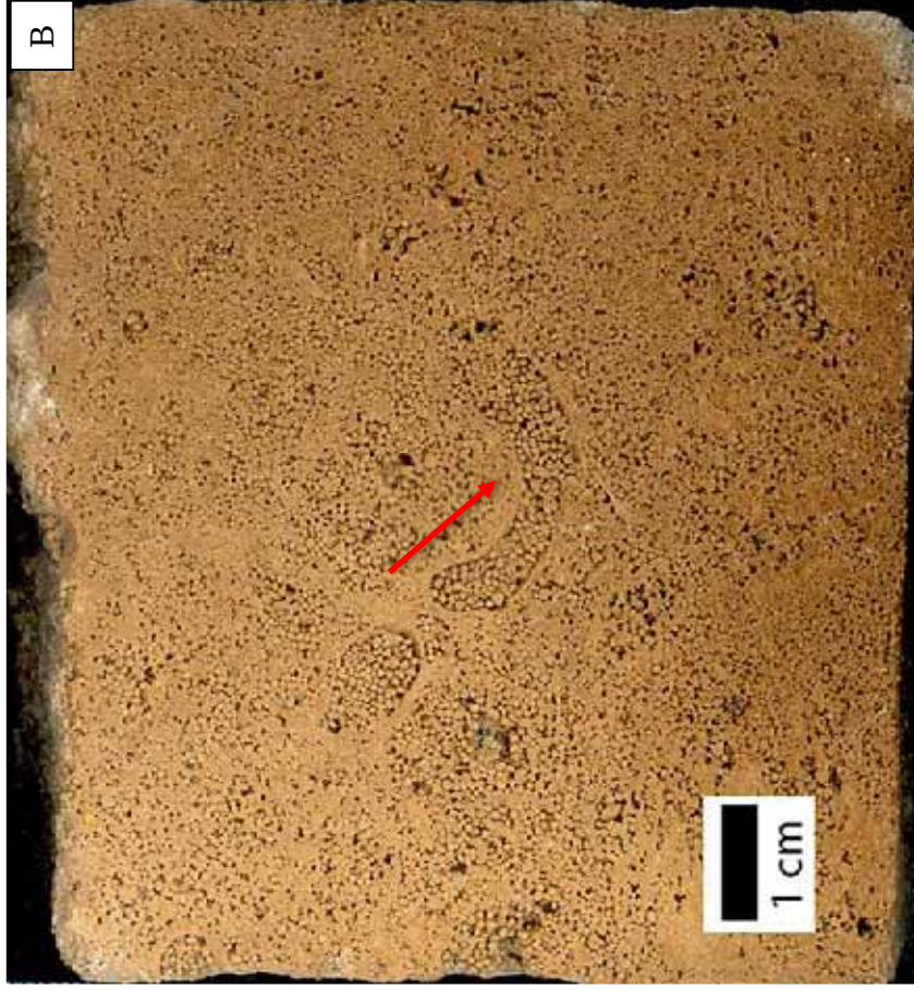
Estampa 1: Imagens obtidas em scanner de seções de testemunho representativa das fácies A e B. A: grainstone oolítico com grãos compostos da fácies A, com estrutura maciça e coloração acinzentada devido à cimentação (Poço A-10, prof. 1874,65m). B: grainstone oncolítico da fácies B, com estrutura maciça a mosqueada, exibindo um tubo de escavação ( burrowing ) preenchido por sedimento indicado pela seta vermelha (Poço A-10, prof. 1842,30m).
