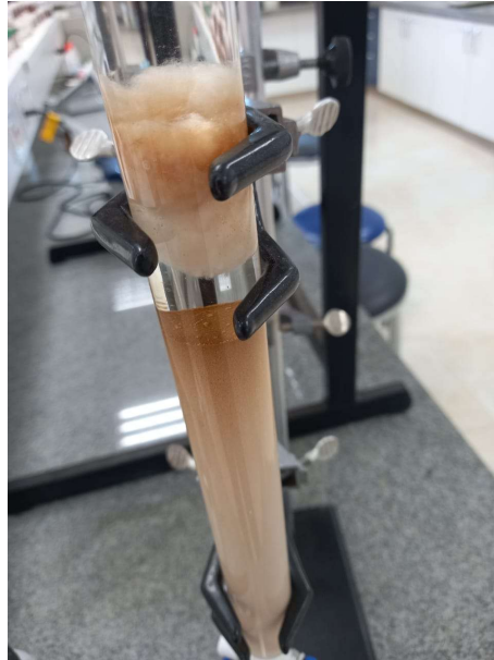
Figura 4 - Coluna cromatográfica com resina DAX-8 durante a operação de filtração
