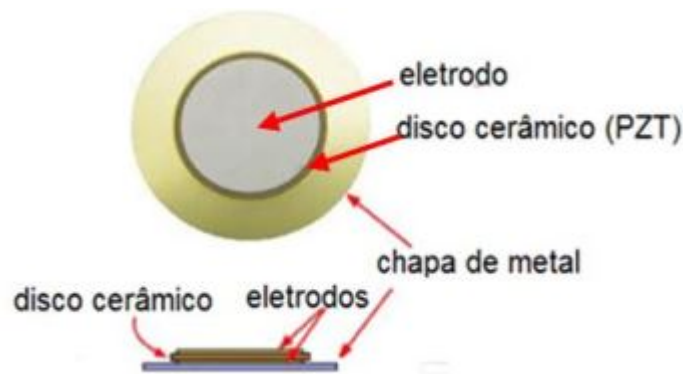
Figura 3.4 – Estrutura do diafragma piezelétrico (SANCHES, 2015)
