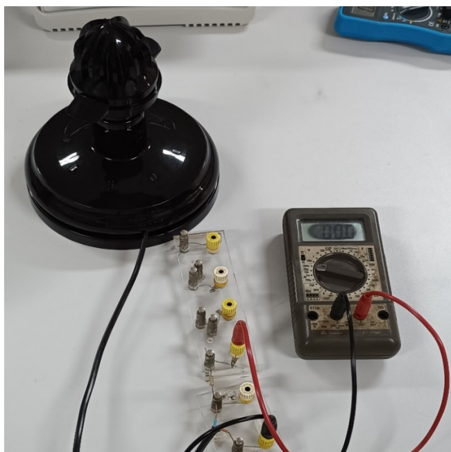
Figura 10: Gerador ligado ao resistor que está em série com o amperímetro na escala mA .
