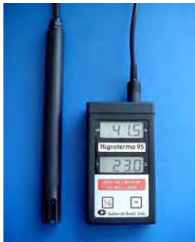
Figura 7. Termohigrômetro digital portátil, modelo Higrómetro 95, da Gulton do Brasil.
