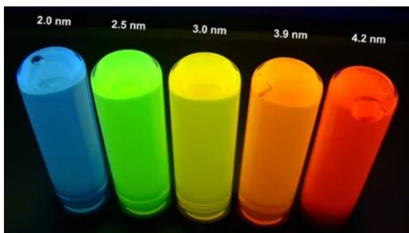
Figura 3- Comparação do espectro luminescente para o Seleneto de Cádmio (CdSe) variando o tamanho do nanocrystal [18].
