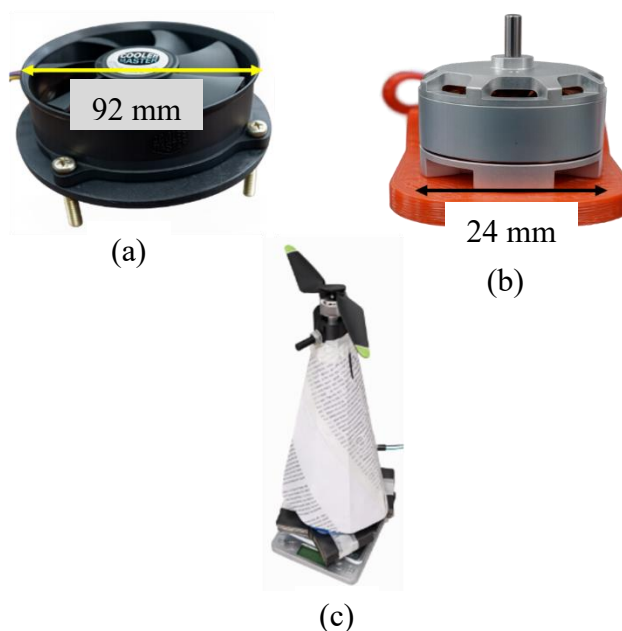
Figura 2.4: Componentes de atuação utilizados nas versões do protótipo aerodinâmico: em (a), DC fans motor utilizado na primeira versão do protótipo, responsável pela ventilação e resfriamento do computador. Em (b), motor elétrico brushless (BLDC) empregado na versão revisada. Fonte: Autor
