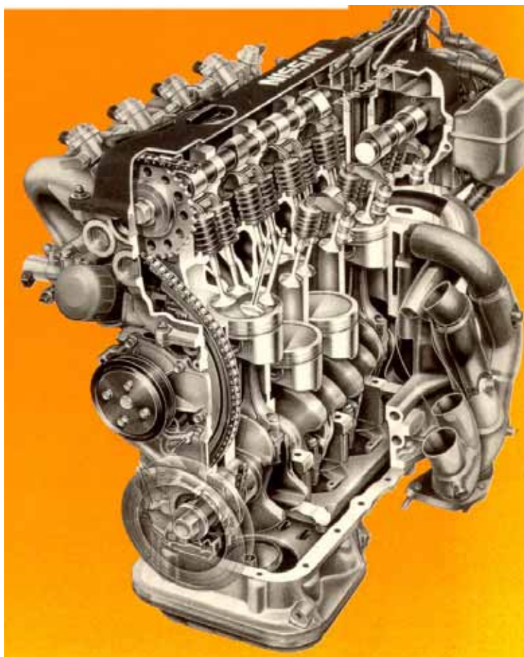
FIGURA 1.1 - Corte parcial de um motor de 4 cilindros em linha
