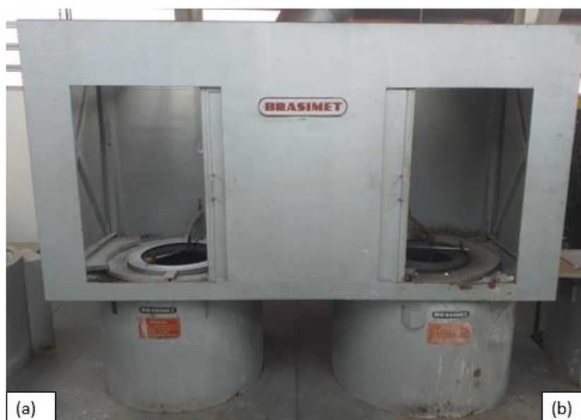
Figura 19. Fornos de resfriamento de banho de sal para (a) particionamento e (b) têmpera parcial.
