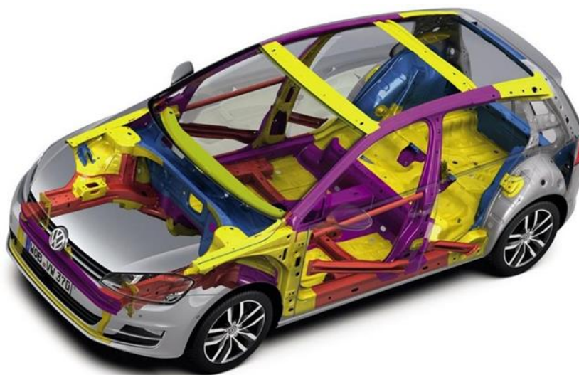
Figura 3. Ilustração da utilização de aços avançados de alta resistência em automóveis.
