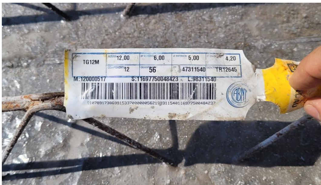
Foto 4 – Identificação da treliça – Empresa A
