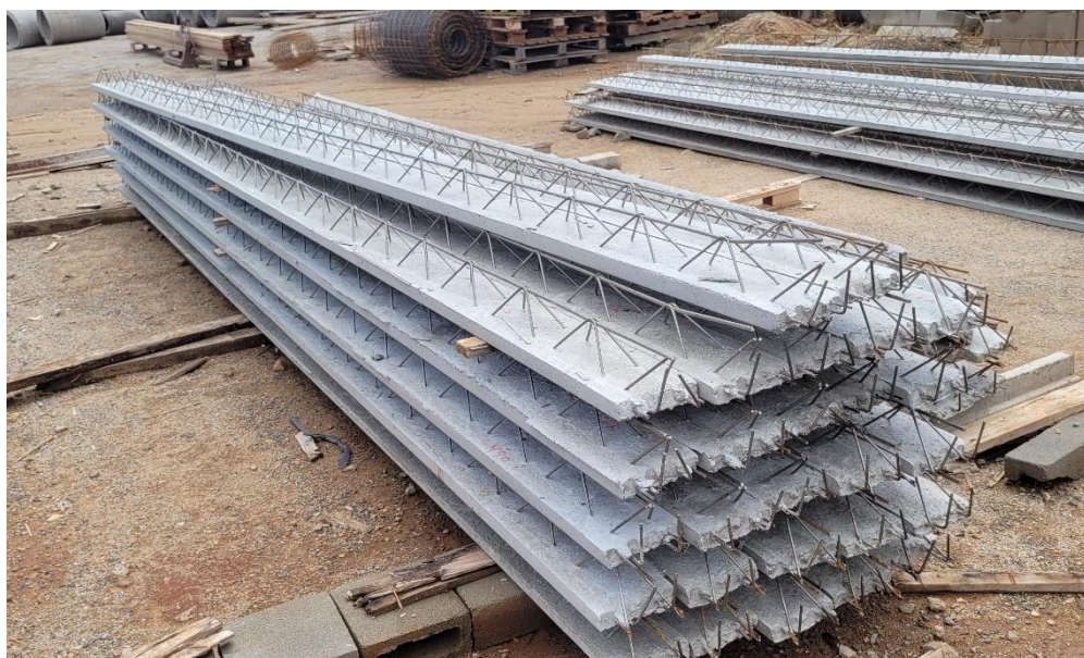
Foto 17 – Armazenamento das vigotas – Empresa B
