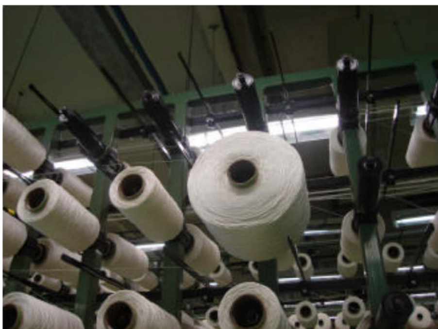
Figura 28 – Exemplo de utilização de bobina de quebra, neste caso com metragem maior do que as bobinas completas utilizadas.
