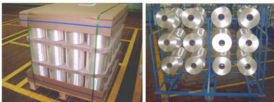
Figura 19 – Bobinas de fio singelo armazenadas em pallets (à esquerda) e em gaiolas (à direita).
