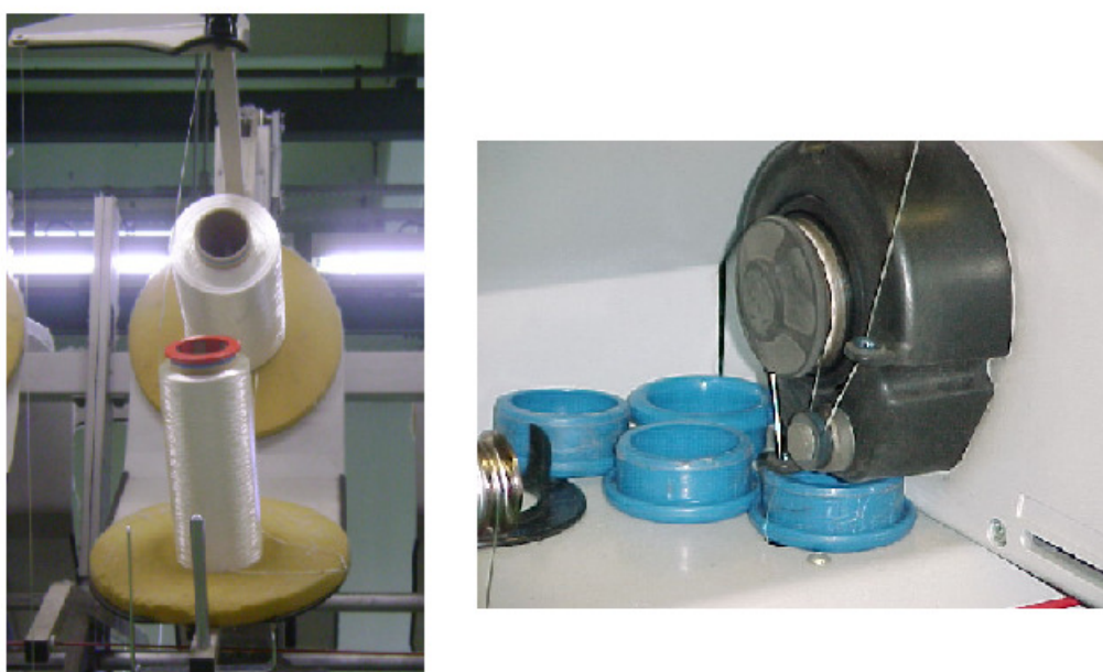
Figura 24 – Exemplo de utilização correta dos Capeletes à esquerda e utilização para função inadequada dos Capeletes à direita.
