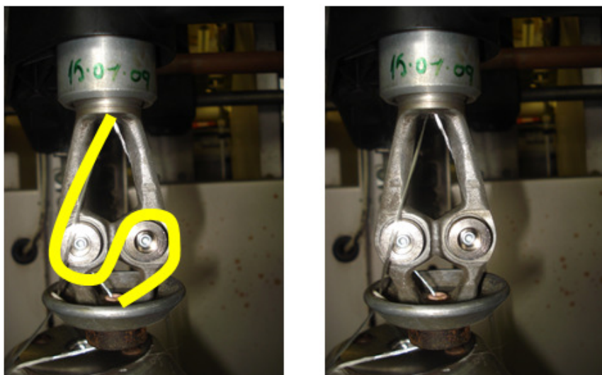
Figura 21 - Exemplo de passamento correto à esquerda e de passamento incorreto à direita (gerador de bobinas de quebra) do fio singelo no Regulador durante o processo de transformação em cableadoras.
