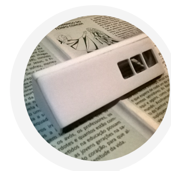
Caixa que envolve as placas, antes da pintura.
