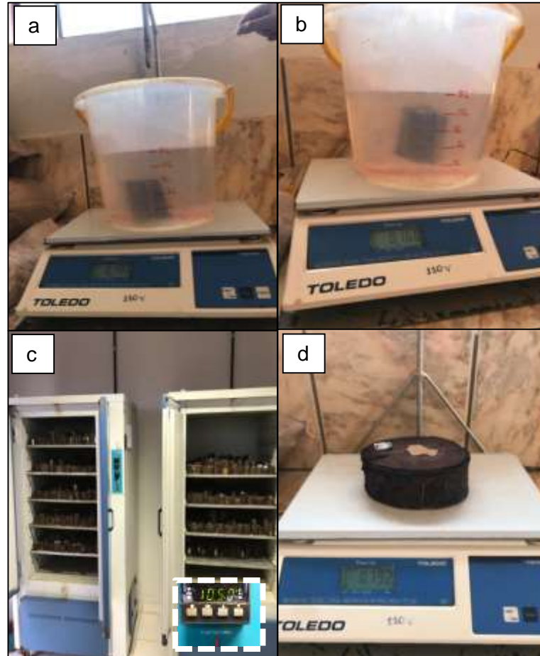
Figura 14. (a) Obtenção peso úmido; (b) Obtenção peso imerso; (c) Discos em estufa (d) Peso seco de Myracrodruon urundeuva aos 24 anos de idade, Laboratório de Genética de Populações, Evolução e Silvicultura da FEIS/UNESP.
