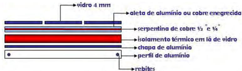
Figura 15 - Ilustração dos componentes do coletor solar
