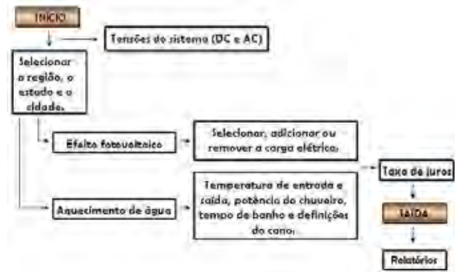
Figura 22 - Fluxograma simplificado do programa para análise da implantação da energia solar
