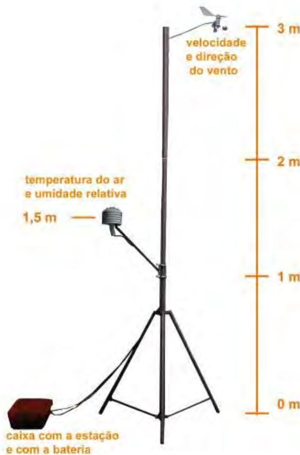
Figura 14: Foto da estação montada em tripé, localização dos equipamentos e cotas das alturas.
