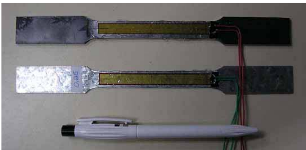
Figura 4.2 – Corpo-de-prova do perfil Ue (acima) e da telha de aço (abaixo), em ambos colados extensômetros elétricos de resistência (strain gauge).
