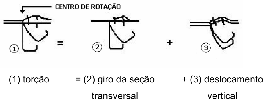
Figura 2.16 - Deformação total dividida em duas partes.
