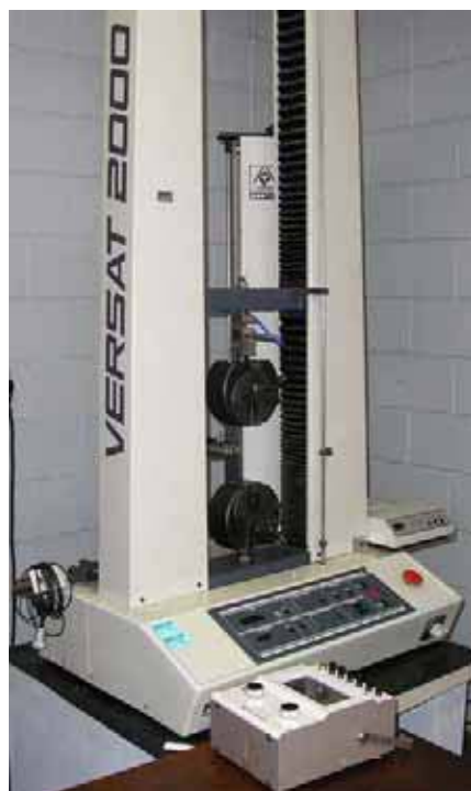
(a) Prensa para Ensaio Universal de Tração, Modelo Versat 2000.
