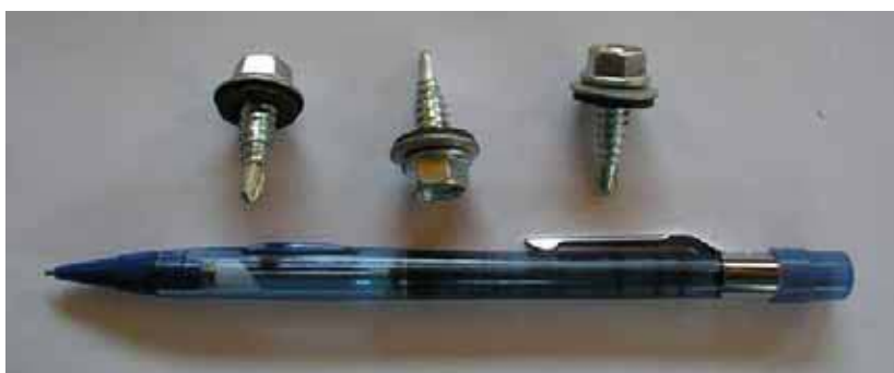
Figura 3.4 - Fixadores autoperfurantes zincados (1/4" x 7/8" com cabeça sextavada 3/8").
