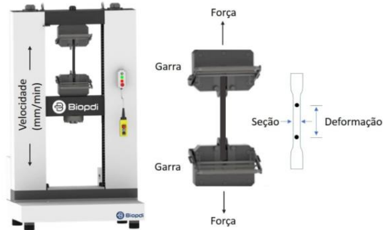
Figura 3 – Esquemática de um ensaio de tração.
