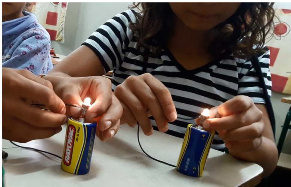
Figura 6 – Alunos acendendo duas lâmpadas com as pilhas invertidas
