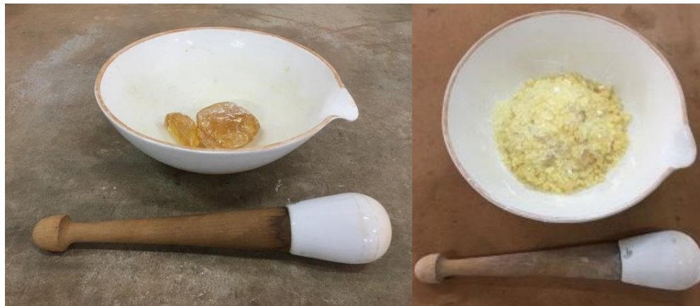
Figura 37 – Processo de maceração do Breu Colofônia em almofariz de porcelana
