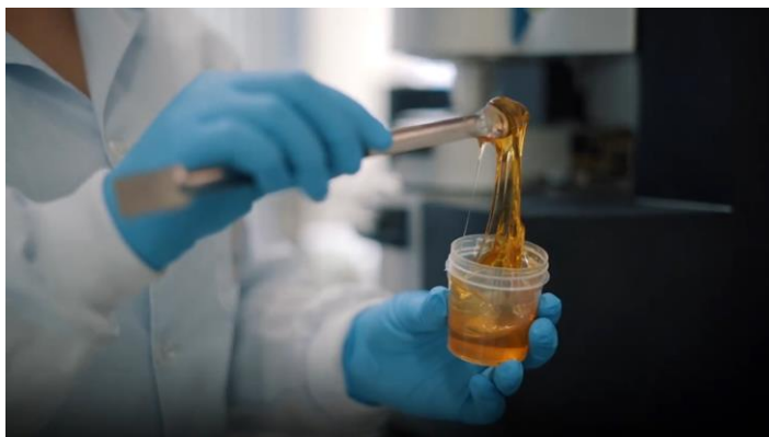
Figura 18 – Breu colofônia após processo de destilação da goma de pinus
