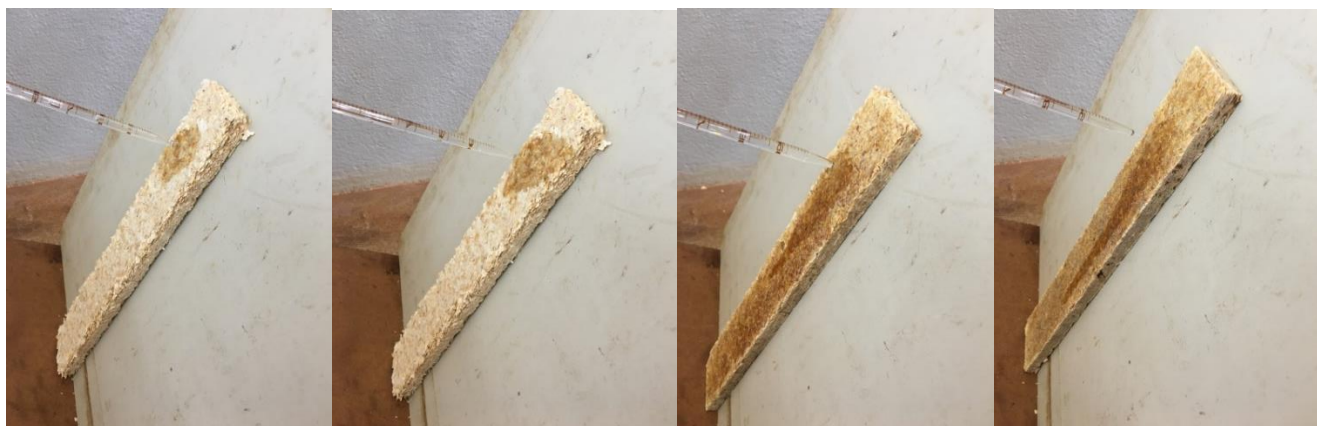
Figura 63 – Escorrimento do tolueno de grau analítico em ensaio de absorção superficial para diferentes composições: (a) C1 10 , (b) C2 10 , (c) C3 20 , e (d) C5 30
