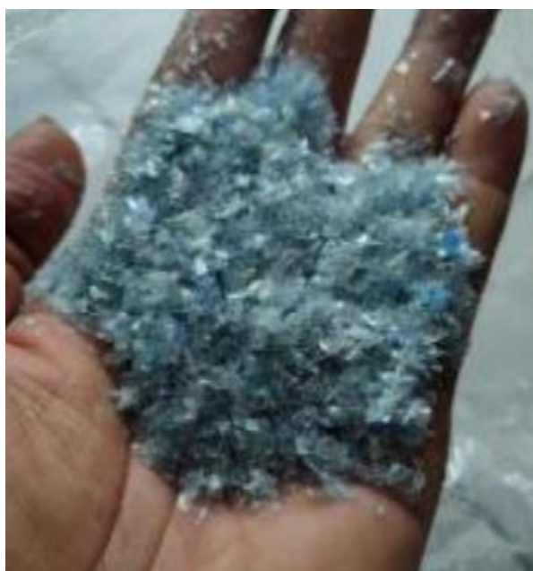
Figura 31 – PET triturado proveniente de resíduos de garrafa plásticas
