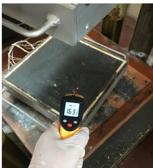
Figura 46 – Aferição da temperatura das faces da prensa hidráulica com equipamento externo
