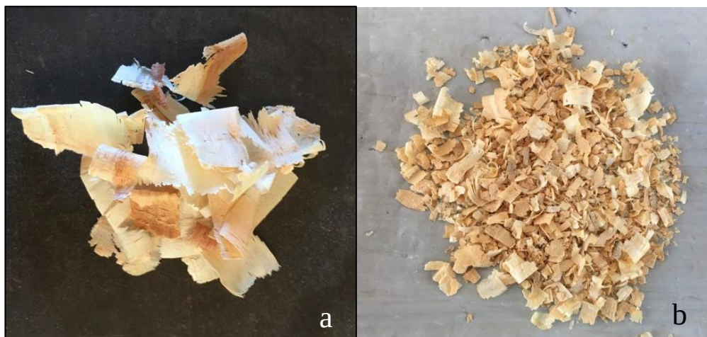
Figura 38 – Madeira de pinus: (a) cavacos, e (b) partículas
