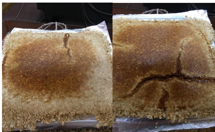
Figura 69 – Painéis de partículas exploratórios produzidos contendo 0% de PETr e 100% de breu colofônia como adesivo alternativo: (a) teor de 40% de adesivo, e (b) teor de 50% de adesivo
