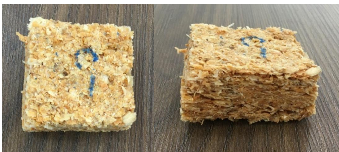
Figura 61 – Corpo de prova n°9 da composição C5 10 após 24 horas de imersão em água deionizada
