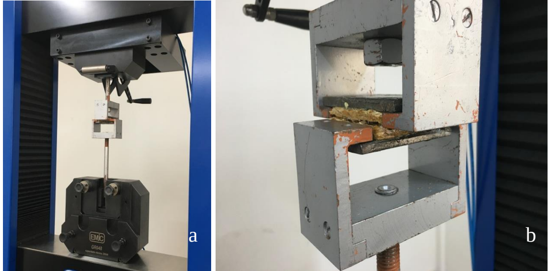
Figura 56 – Corpo de prova posicionado na máquina universal de ensaios: (a) antes da ruptura, e (b) após a ruptura
