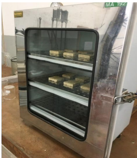
Figura 50 – Ambiente com controle de temperatura e umidade
