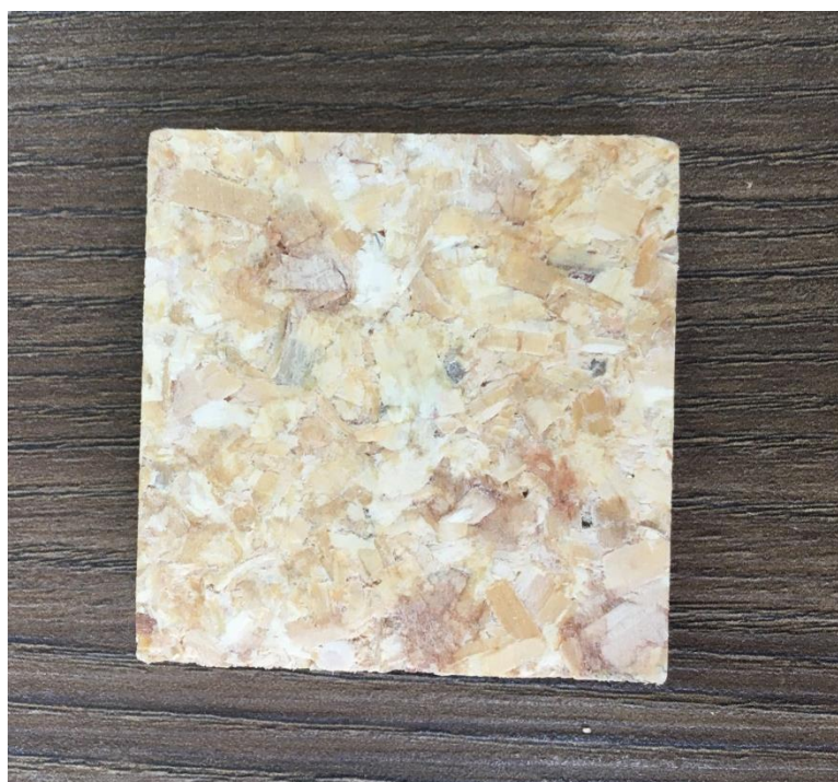
Figura 51 – Exemplo de corpo de prova com dimensões de 50 mm x 50 mm da pertencente à composição C1 30
