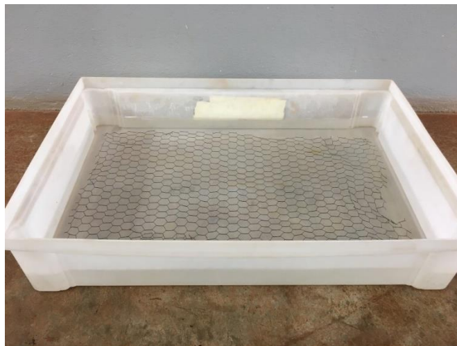
Figura 52 – Malha metálica para garantir a submersão dos CP's ensaiados em água deionizada
