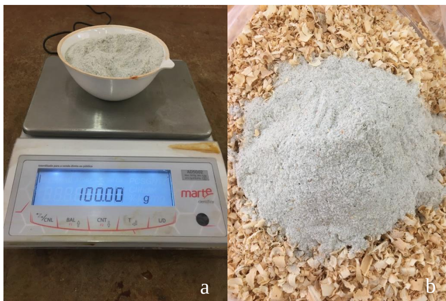
Figura 44 – Preparação das composições propostas: (a) representação da pesagem dos materiais, e (b) homogeneização prévia da composição C1 10
