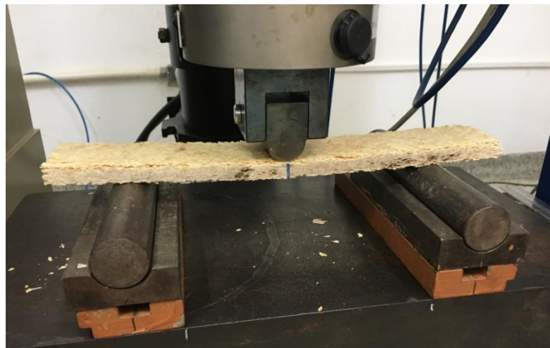
Figura 55 – Ensaio de flexão estática de um CP da composição C1 20
