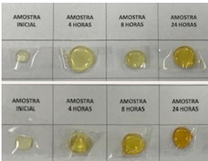
Figura 34 – Amostras de resina de breu colofônia após submissão a ensaio de envelhecimento em estufa por períodos de 4, 8 e 24 horas
