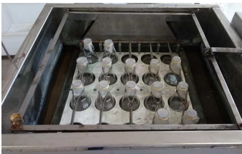
Figura 10 - Ensaio de cinética de adsorção em mesa agitadora à temperatura constante de 25°C.
