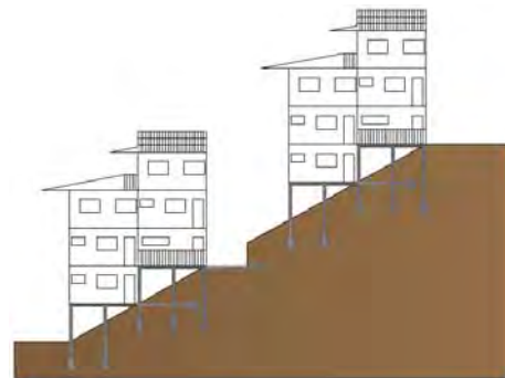
Figura 82: corte esquemático, terreno com inclinação de 51% Fonte: Autor.
