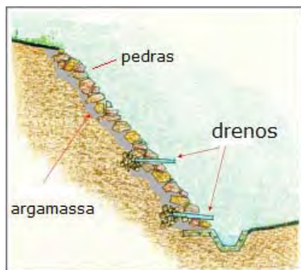
Figura 49: Detalhe proteção artificial com pedras. Fonte: Adaptado (CUNHA, 1991).
