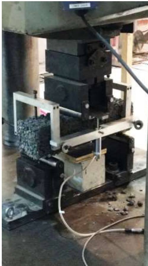
Figura 10 – Ensaio de tração na flexão
