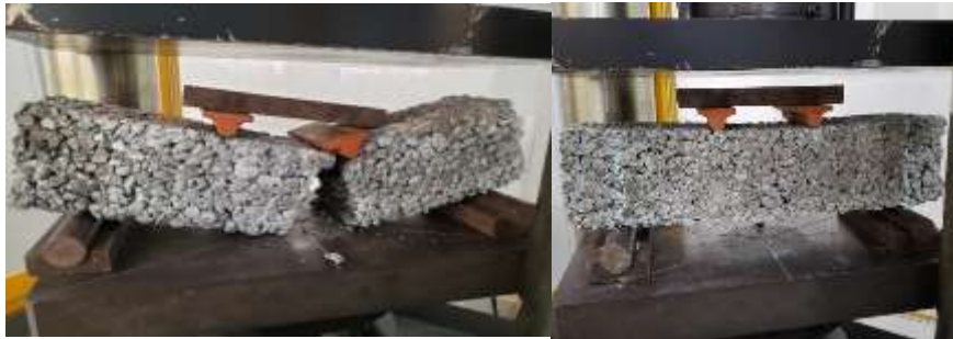
Figura 43 - Análise Visual Após Carga Máxima
