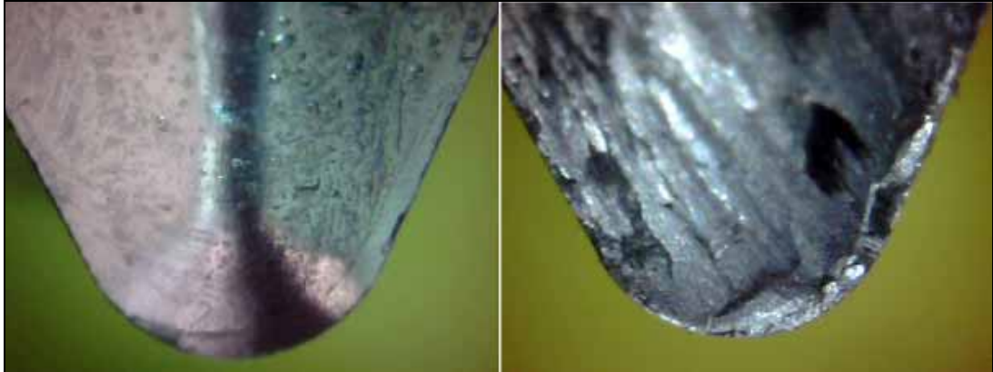
Figura 68 – Pastilha de metal duro polido, nova e após usinagem do CDP3
