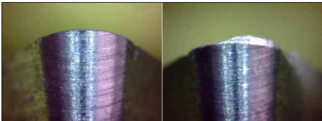
Figura 70 – Pastilha de metal duro polido, nova e após usinagem do CDP3
