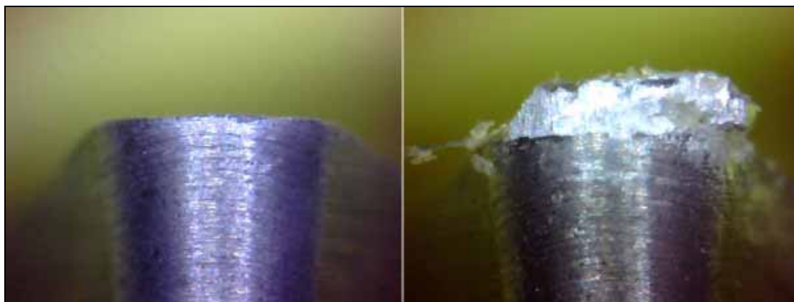
Figura 75 – Pastilha de metal duro recoberto com \text{TiB}_2 , nova e após usinagem do CDP5
