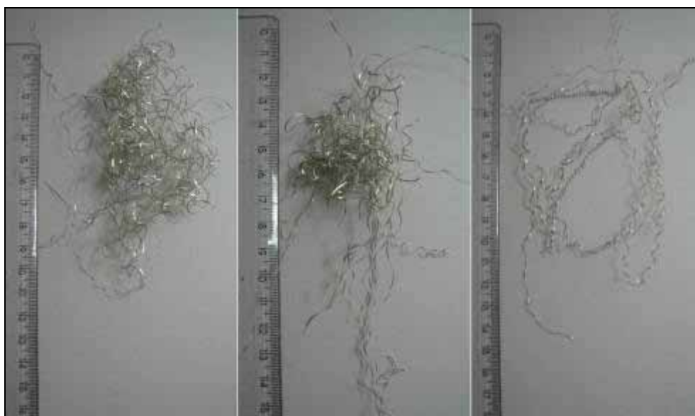
Figura 96 – Pastilha de metal duro recoberta com \text{TiB}_2 ; profundidade de corte de 0,20 mm; avanços de 40, 70 e 100 mm/min, respectivamente
