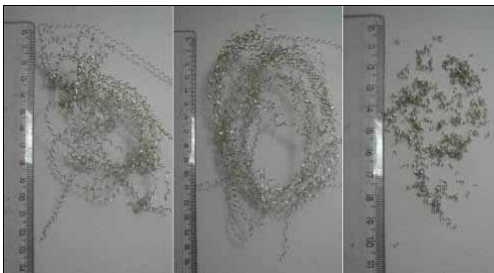
Figura 94 – Pastilha de metal duro recoberta com \text{TiB}_2 ; profundidade de corte de 0,50 mm; avanços de 40, 70 e 100 mm/min, respectivamente
