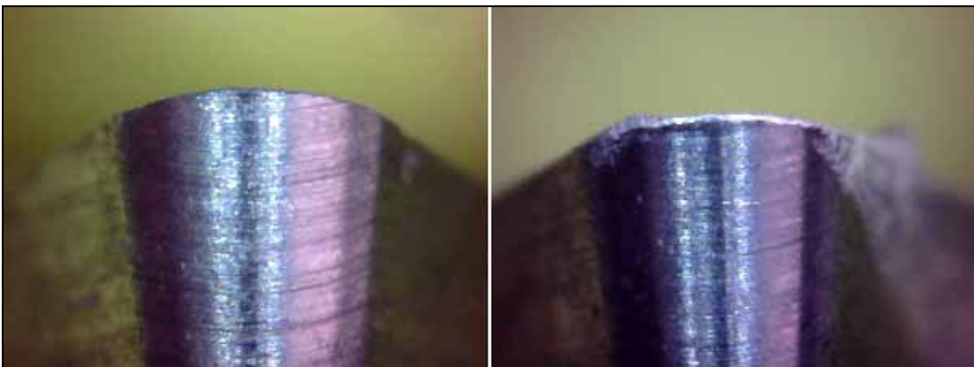
Figura 67 – Pastilha de metal duro polido, nova e após usinagem do CDP2
