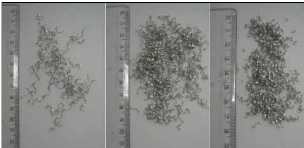
Figura 83 – Pastilha de metal duro polido; profundidade de corte de 0,35 mm; avanços de 40, 70 e 100 mm/min, respectivamente
