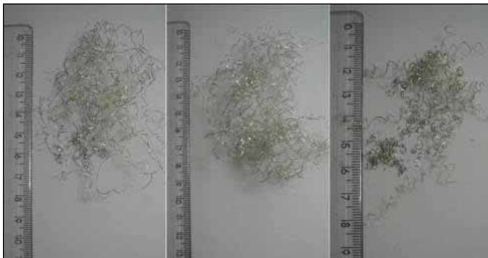
Figura 103 – Ferramenta de aço rápido; profundidade de corte de 0,50 mm; avanços de 40, 70 e 100 mm/min, respectivamente
