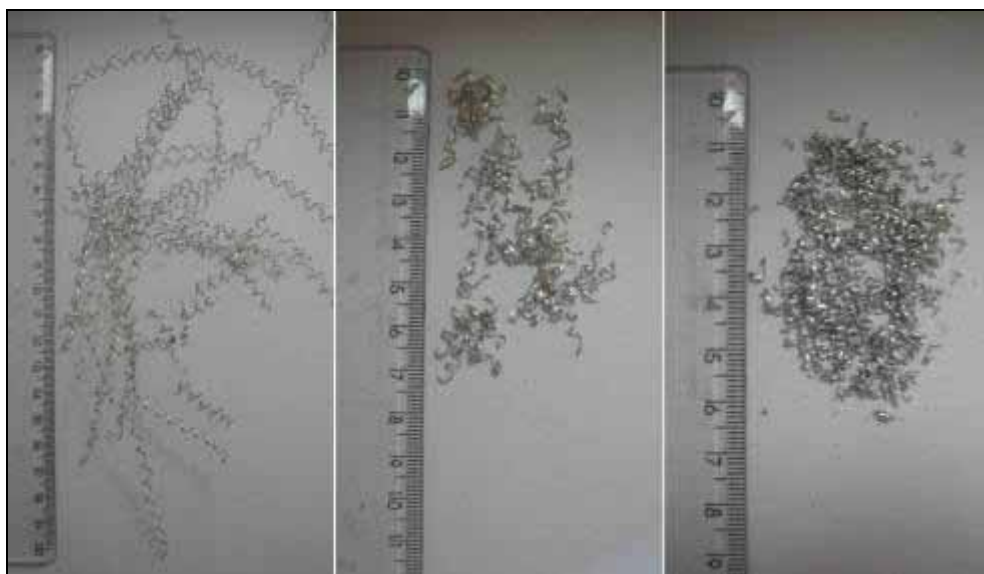
Figura 80 – Pastilha de metal duro polido; profundidade de corte de 0,35 mm; avanços de 40, 70 e 100 mm/min, respectivamente
