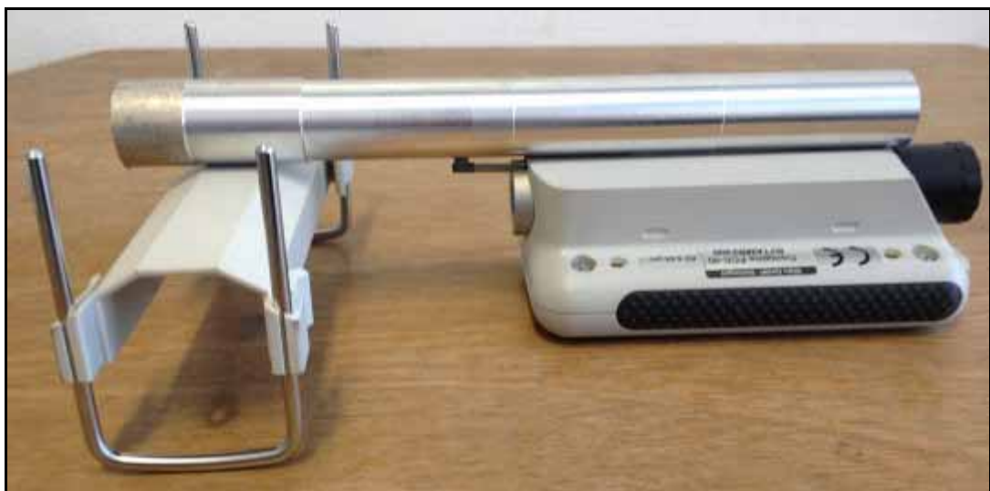
Figura 31 – Suporte e apalpador do rugosímetro
