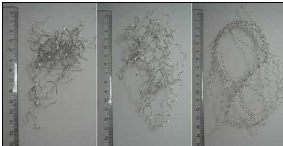
Figura 95 – Pastilha de metal duro recoberta com \text{TiB}_2 ; profundidade de corte de 0,35 mm; avanços de 40, 70 e 100 mm/min, respectivamente
