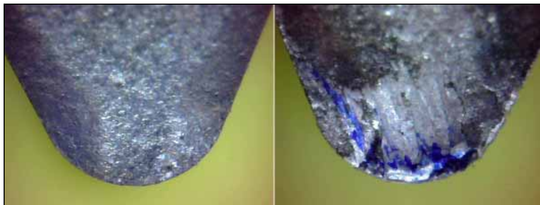
Figura 76 – Pastilha de metal duro recoberto com \text{TiB}_2 , nova e após usinagem do CDP6
