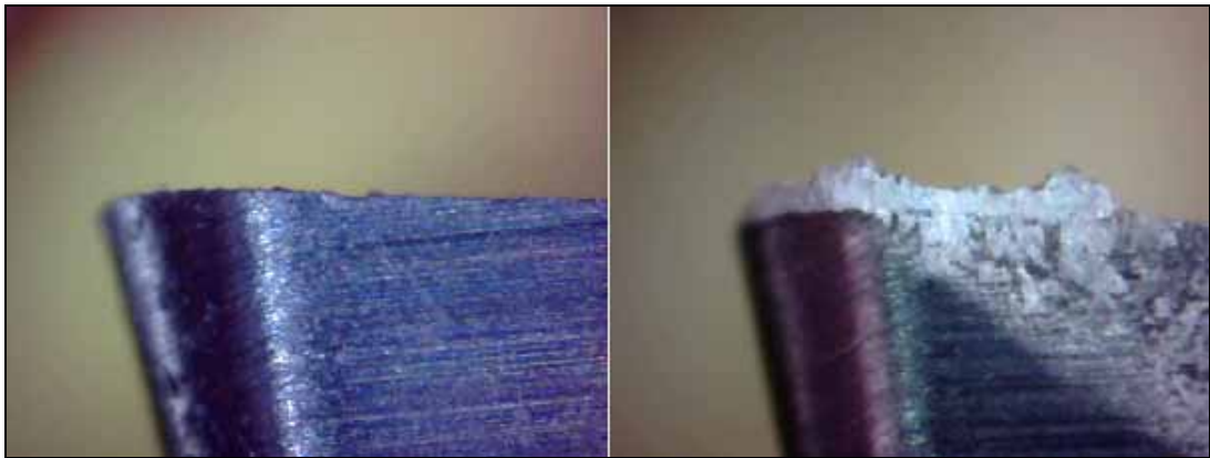
Figura 66 – Pastilha de metal duro polido, nova e após usinagem do CDP2
