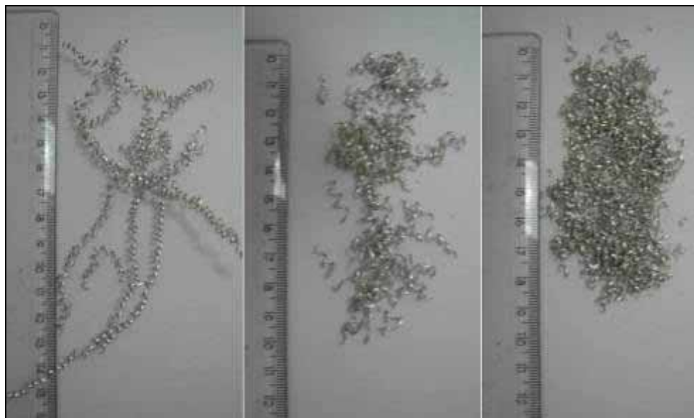
Figura 82 – Pastilha de metal duro polido; profundidade de corte de 0,50 mm; avanços de 40, 70 e 100 mm/min, respectivamente
