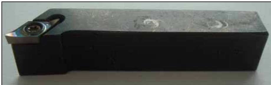
Figura 37 – Pastilha de metal duro com recobrimento de \text{TiB}_2 no suporte
