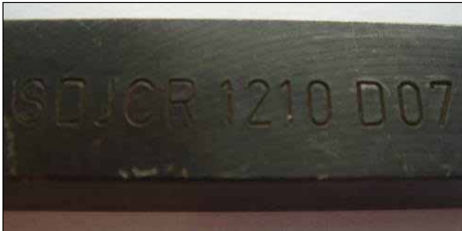
Figura 39 – Suporte utilizado para as pastilhas de metal duro
