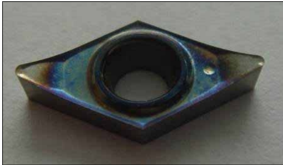
Figura 36 – Pastilha de metal duro com recobrimento de \text{TiB}_2
