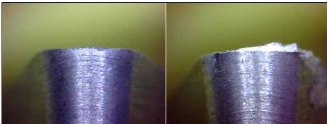
Figura 78 – Pastilha de metal duro recoberto com TiB_2 , nova e após usinagem do CDP6
